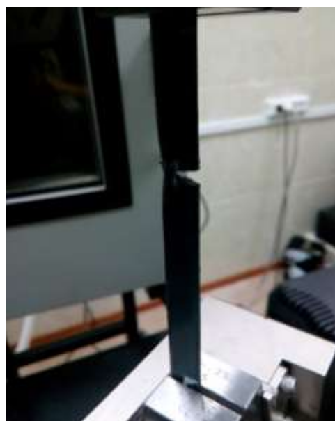
рисунок 4.1 – Образец в захватах и разрушение образца
