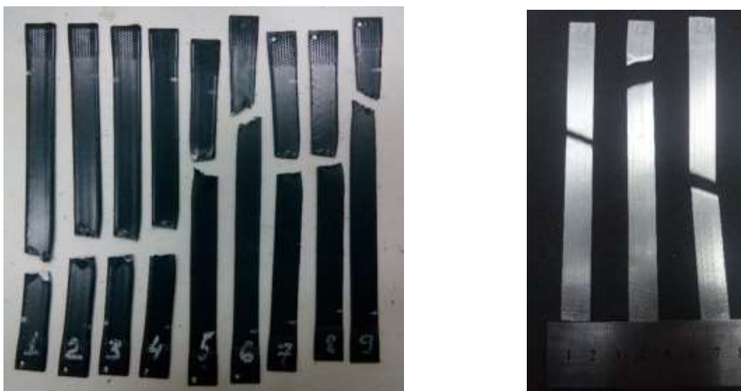
рисунок 4.2 – Испытанные на растяжение образцы с/без покрытий
