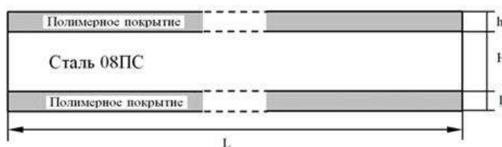
Рисунок 3.3 – Модель стальных образцов с полимерным покрытием
