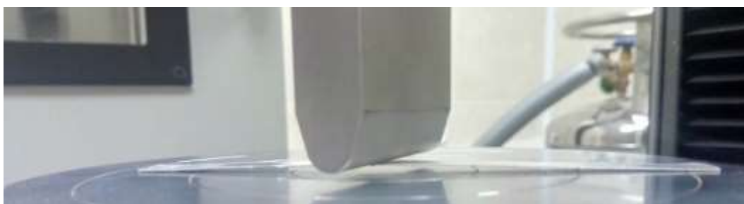
рисунк 3.6– Испытания образцов для определения начального прогиба
