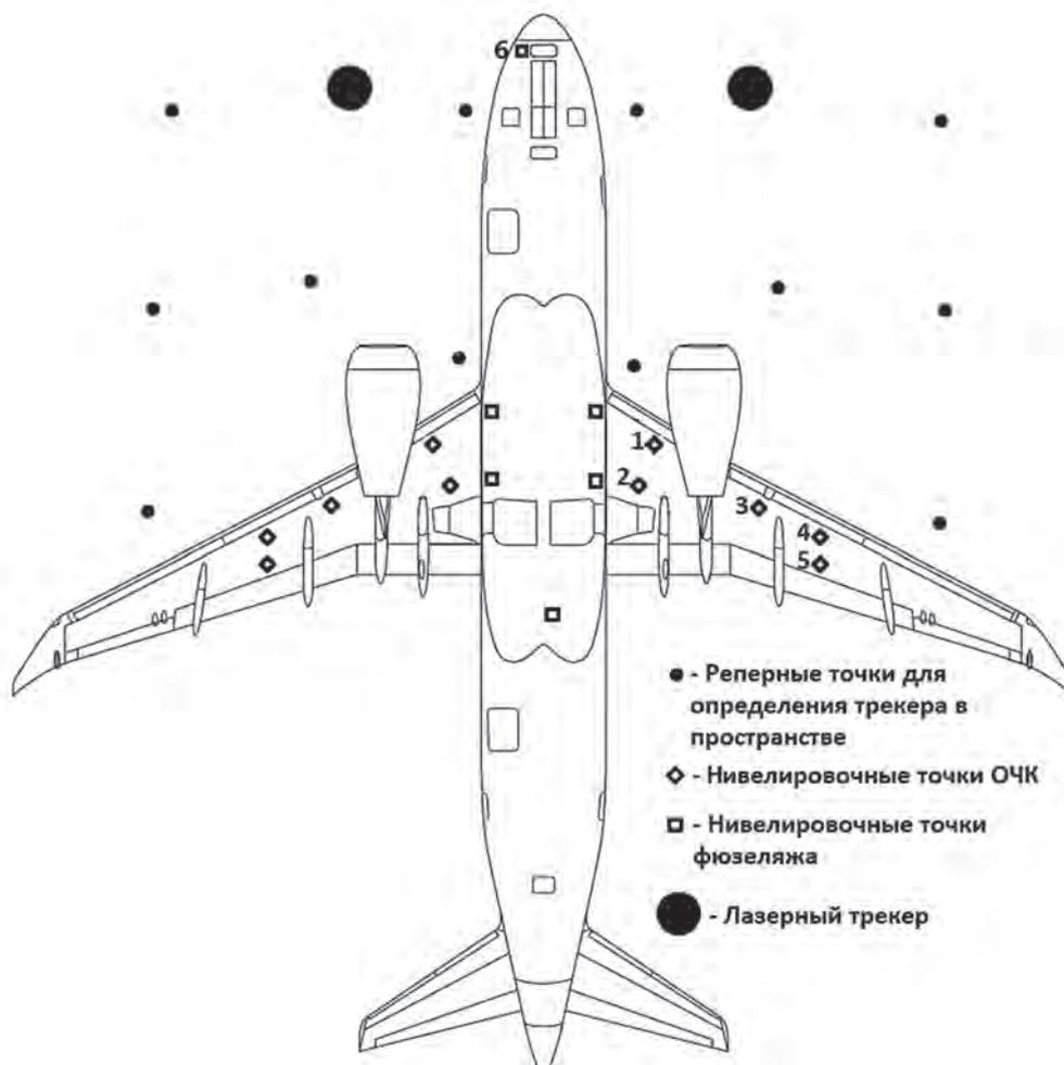
Рис. 2. Принципиальная схема расположения контрольных точек
