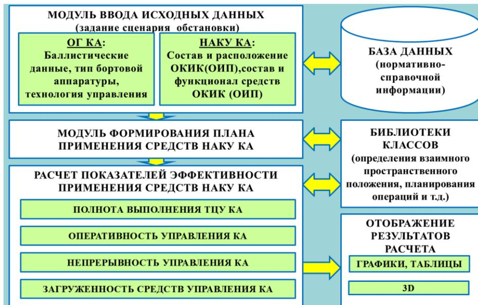
Рисунок 2 – Структура программного средства оценивания эффективности функционирования НАКУ
