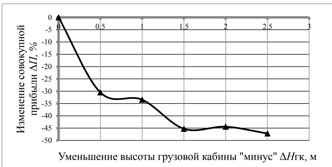
Рисунок 13 - Зависимость совокупной прибыли Ан-124-100 при уменьшении максимальной высоты грузовой кабины
