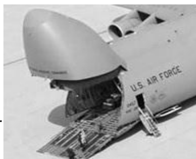
Рисунок 6 – отклоняемые части фюзеляжа ТС
