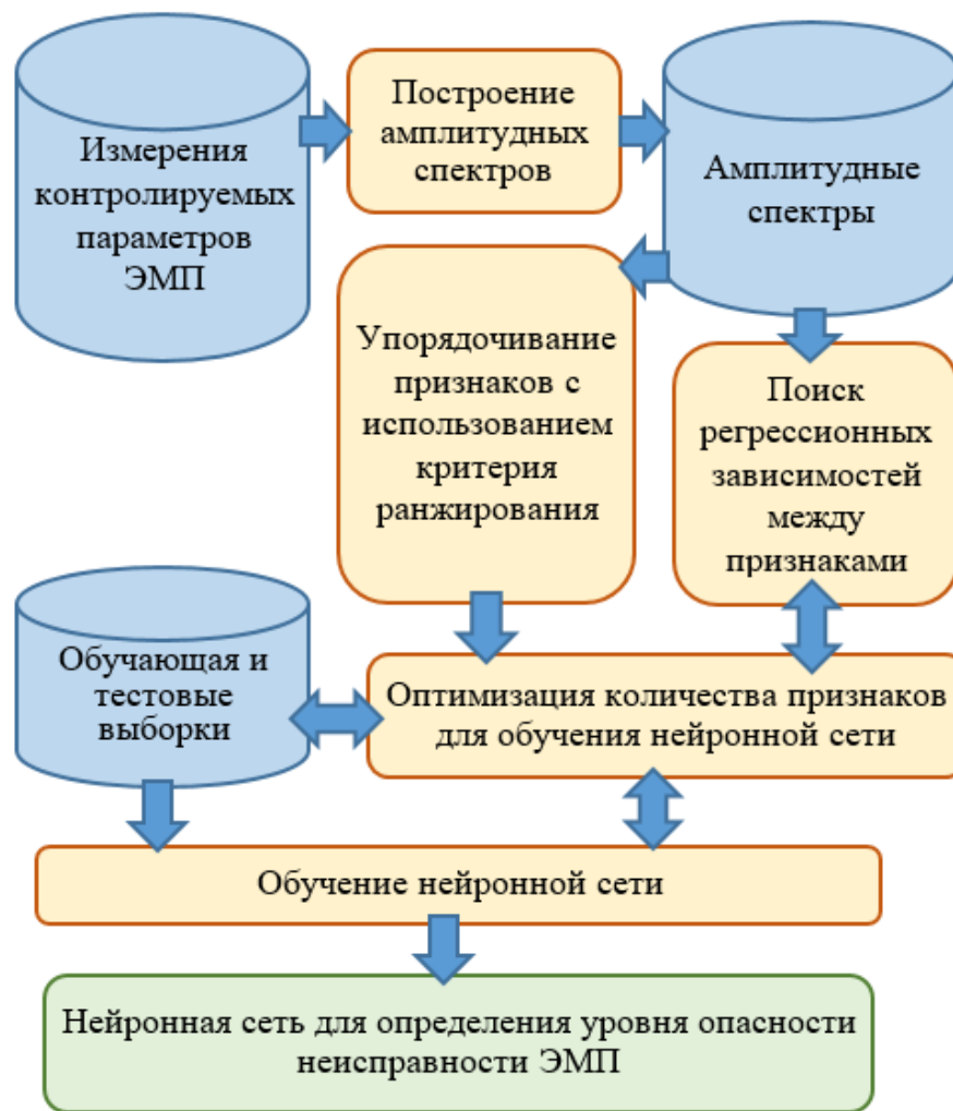
Рисунок 86 – Схема анализа данных обора признаков для определения уровня опасности ЭМРП
