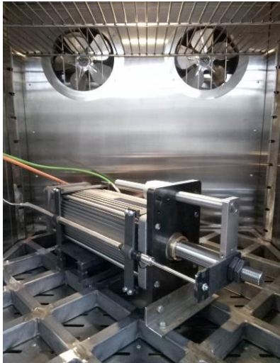
Рисунок 52 – Зависимости активного тока статора ЭМРП с РВП без нагрузки от скорости управляющего сигнала и температуры окружающей среды (справа) при проведении испытаний в климатической камере (слева)
