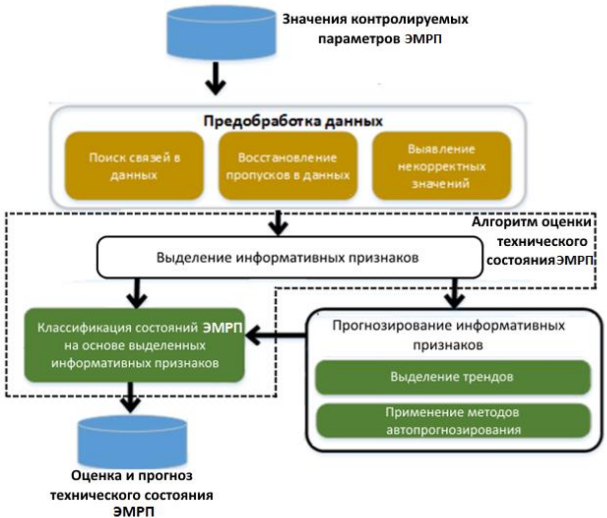
Рисунок 65 – Схема анализа данных в режиме использования модели оценки и прогноза технического состояния ЭМРП
