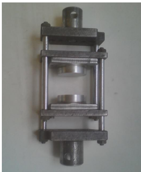
Рисунок 18. Общий вид приспособления для исследования прочности на сжатие
