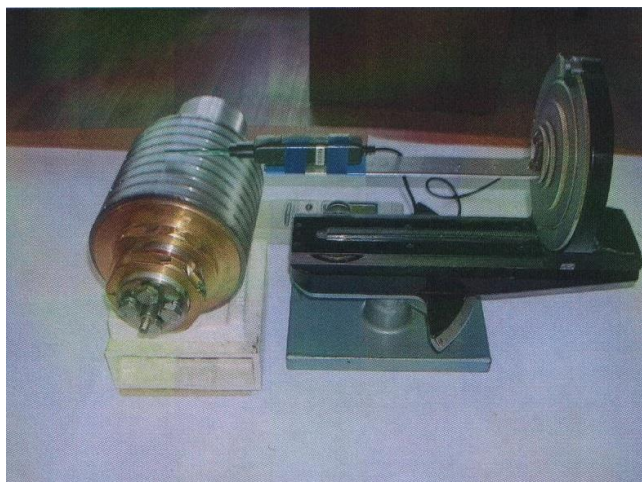
Рисунок 3.28 – Установка для измерения осевой составляющей индукции магнитного поля над ротором
