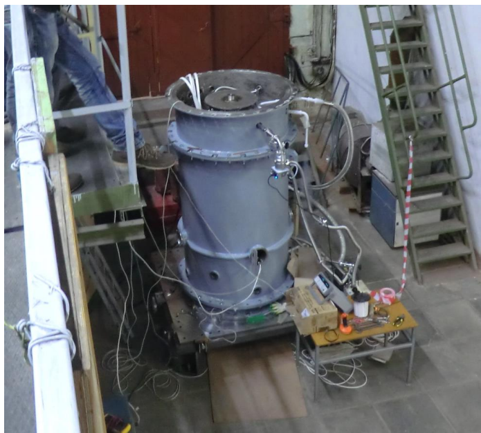
Рисунок 5.3-Опытный образец ЭМН с магнитным ВТСП подвесом при проведении испытаний
