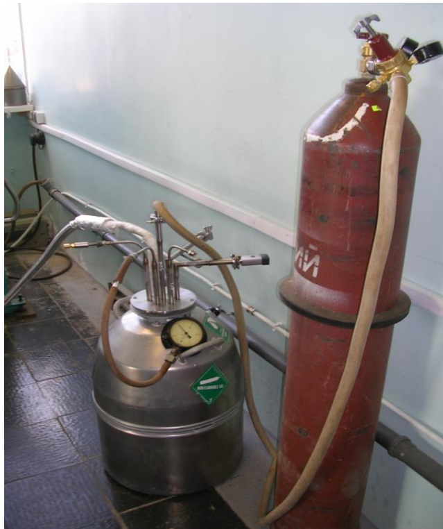
Рисунок 5.10-Общий вид расходной системы криообеспечения
