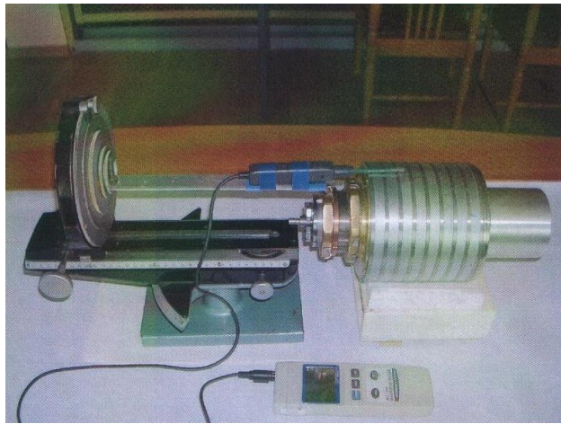
Рисунок 3.27 – Установка для измерения радиальной составляющей магнитной индукции на различных расстояниях от шима
