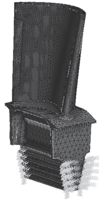
Рис. 4. КЭ-модель лопатки рабочего колеса и граничные условия
