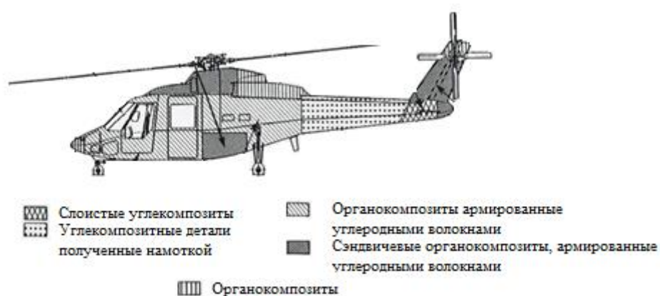
Рисунок 1 – Использование армированных ПКМ в конструкции пассажирского самолета фирмы Airbus (а) и вертолета Sikorsky S-75 (б)
