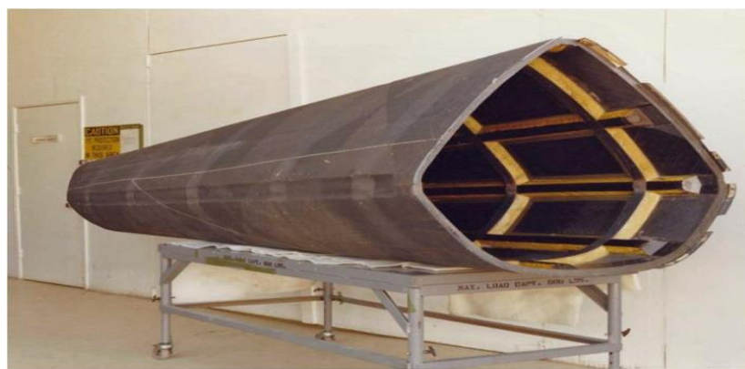
Рисунок 2 – Фотография подкрепленного хвостового конуса вертолета Sikorsky S-75
