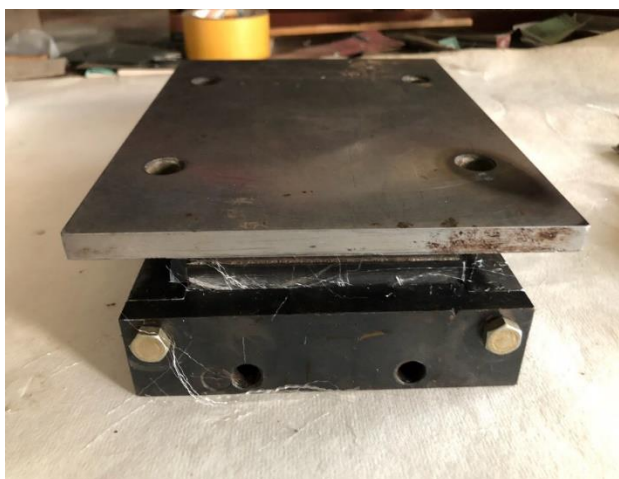
Рисунок 15 – Оснастка для прессования пластин из ПКМ
