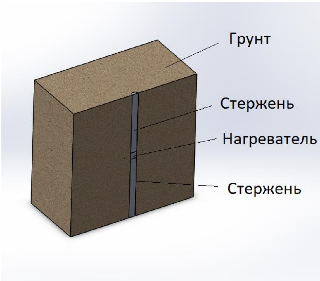
Рис. 5. Общий вид модели стержневого термозонда, используемой в расчете. Вид представлен в разрезе
