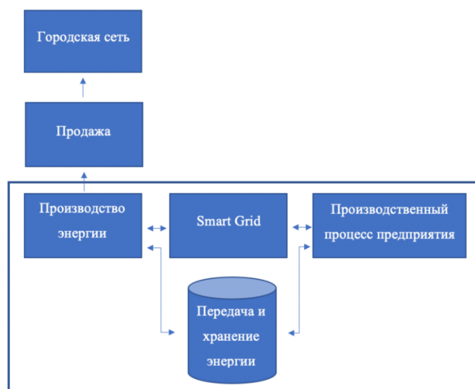
Рис. 1.11. Структура технологического комплекса Smart Grid в рамках предприятия (источник: построено автором)
