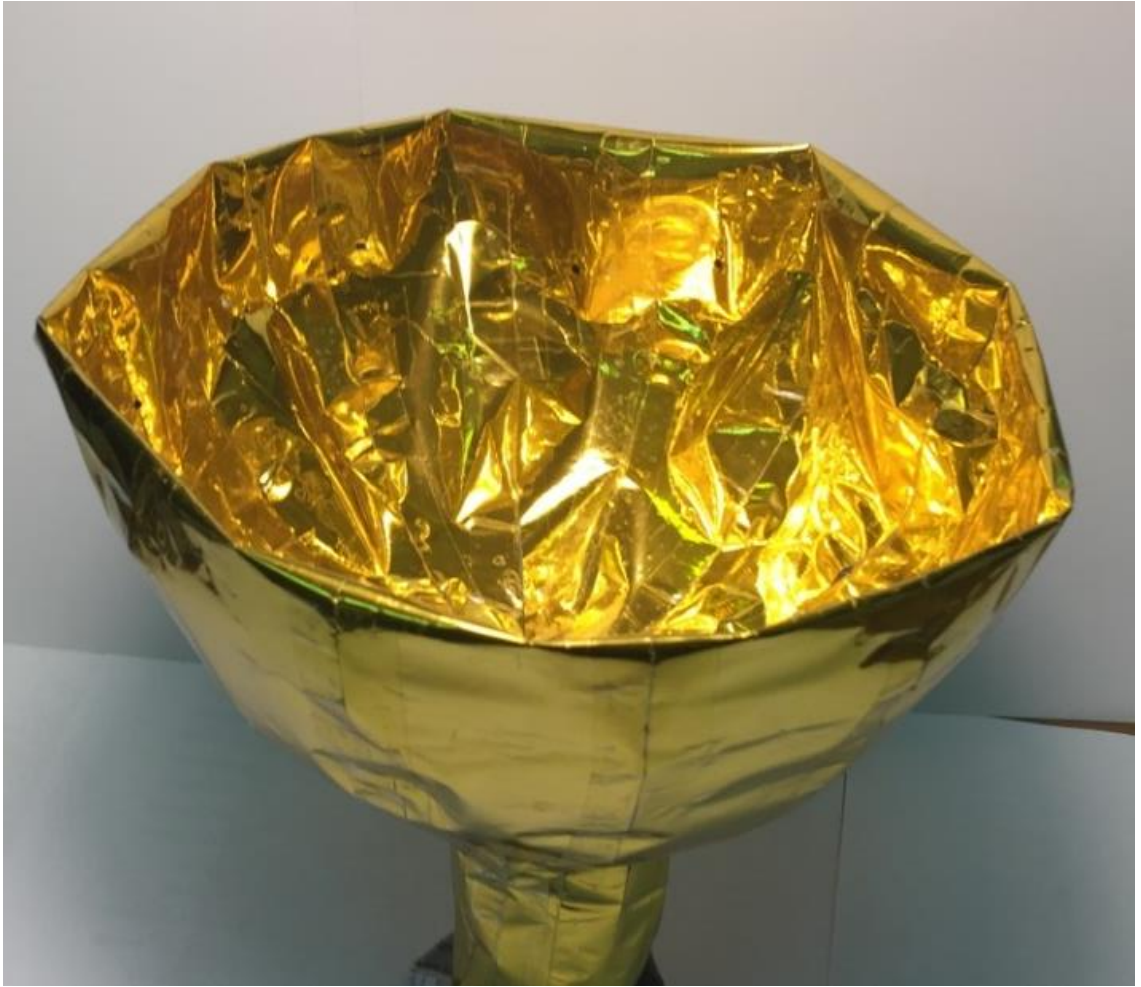
Рисунок 3.10. Складывание оболочки в двойную полусферу
