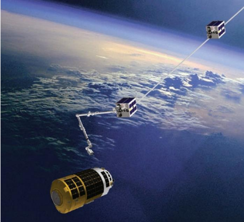
Рисунок 1-10. Система ElectroDynamic Debris Eliminator для захвата одиночного крупногабаритного техногенного космического объекта [29]
