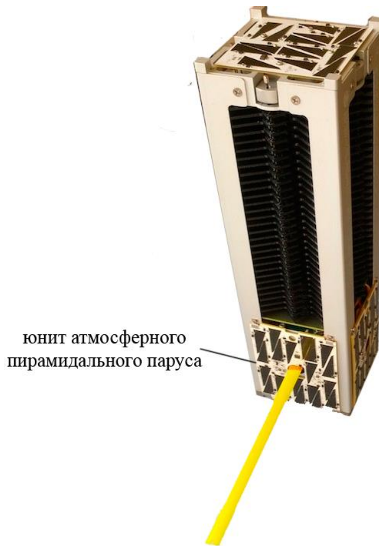
Рисунок 1-20. Макет наноспутника «Маяк» для наземной отработки раскрытия атмосферного пирамидального паруса [57]
