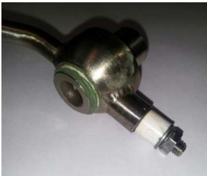
Рисунок 5.14 – Впервые изготовленная принципиально новая электропневматическая форсунка с электрическим полем для газотурбинного авиационного двигателя типа ПД-14
