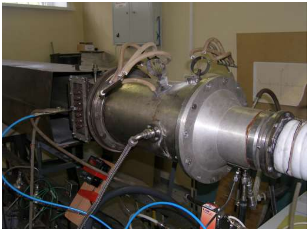
Рисунок 6.1,а – Огневые испытания ЭУВТ в СГАУ: сверху под камерой сгорания – ЭУВТ), внизу – модельная камера сгорания
