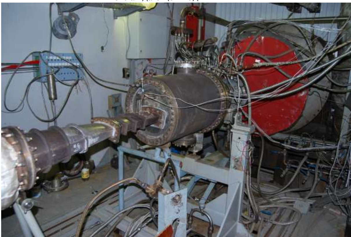
Рисунок 6.37 – Пятигорелочный отсек КС авиадвигателя ПД-14. На выходном мерном участке видны гребенки температуры и пробоотборники вредных веществ продуктов сгорания керосино-воздушной смеси
