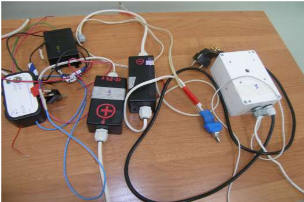
Рисунок 5.42 – Электронные устройства ЭУВТ с различными электрическими параметрами выходного напряжения, подаваемого на электроды ЭУВТ
