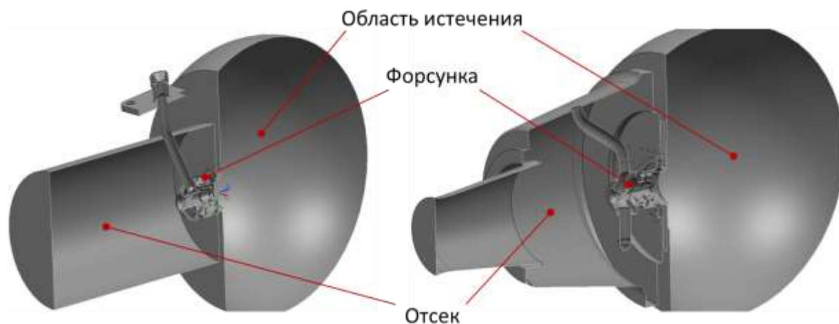
Рисунок 5.28 – Модели ФМ-1 (слева) и ЭПФ (справа) в установках по определению характеристик распыла топлива
