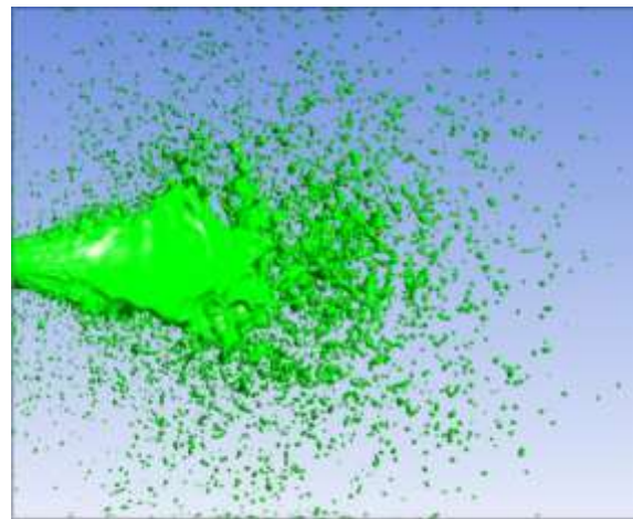
Рисунок 5.24 – Распределения капель жидкости по сечению канала при различных моделях турбулентности
