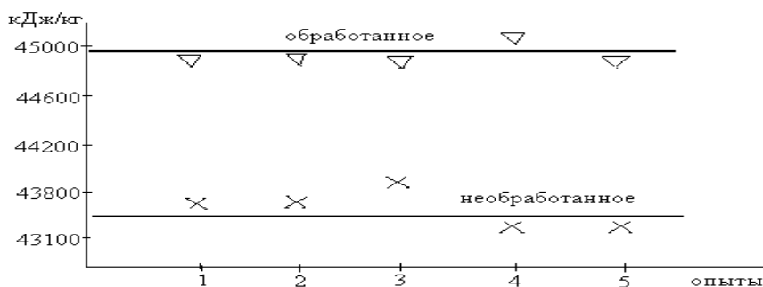
Рисунок 1.3 – Прирост теплоты сгорания дизельного топлива, обработанного постоянным электрическим полем
