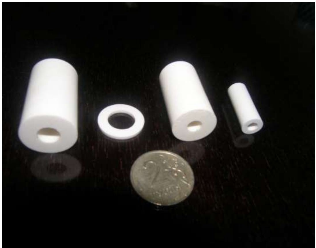
Рисунок 3.11 – Изготовленные заготовки из корундоциркониевой керамики для разработанной электропневматической форсунки
