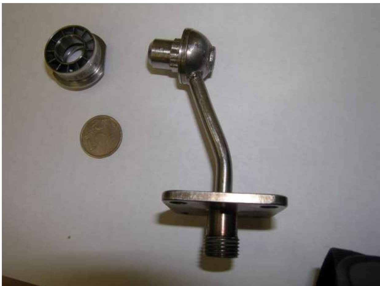
Рисунок 5.40 – Разработанный с позиций динамического конструирования экспериментальный образец пневматической форсунки с наружным воздушным завихрителем с улучшенными характеристиками распыла для авиационного двигателя типа ПД-14
