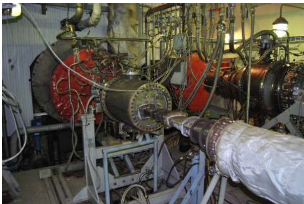
Рисунок 6.34 – Полноразмерная камера сгорания авиационного газотурбинного двигателя ПД-14 с топливными форсунками
