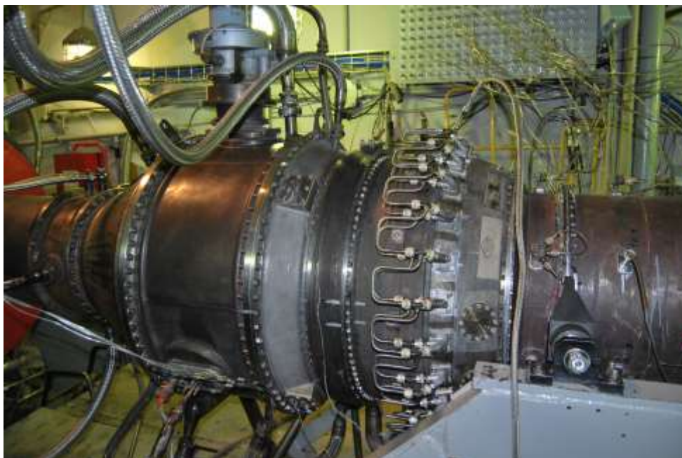
Рисунок 6.34 – Полноразмерная камера сгорания авиационного газотурбинного двигателя ПД-14 с топливными форсунками
