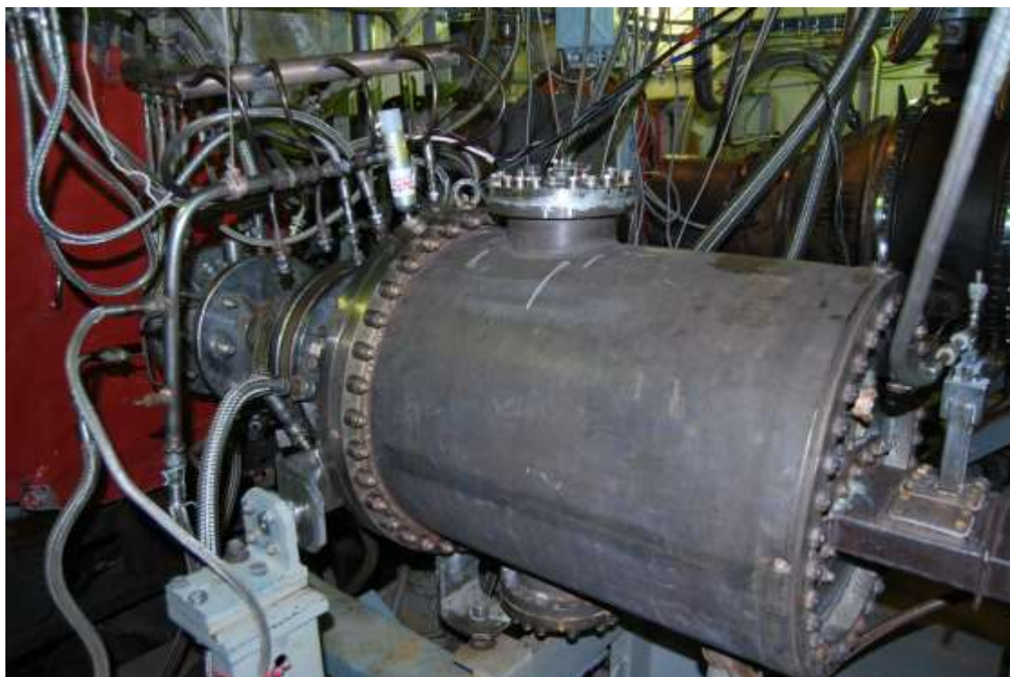
Рисунок 6.40 – ЭУВТ (вверху с красной надписью) в цепи подвода керосина к трем форсункам внешнего контура пятигорелочного отсека. Справа ЭУВТ виден белый провод дистанционного подвода электрического напряжения
