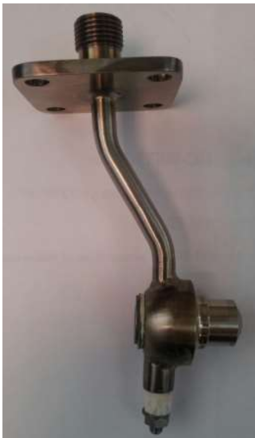
Рисунок 5.14 – Впервые изготовленная принципиально новая электропневматическая форсунка с электрическим полем для газотурбинного авиационного двигателя типа ПД-14
