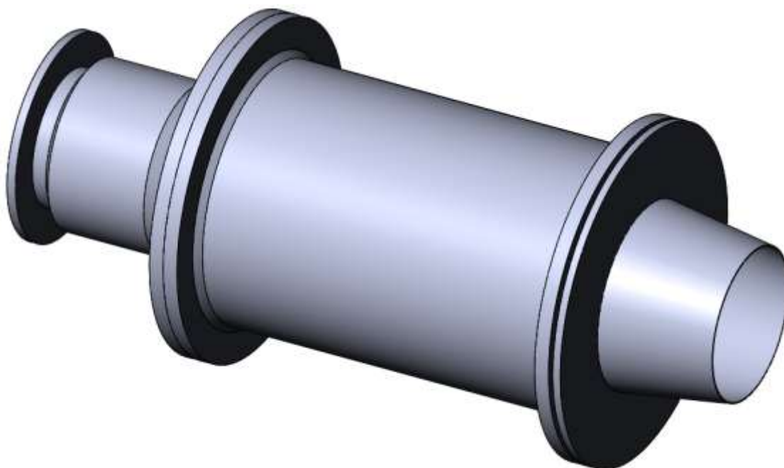
Рисунок 6.5 – CAD–модель модельной камеры сгорания , вид в изометрии
