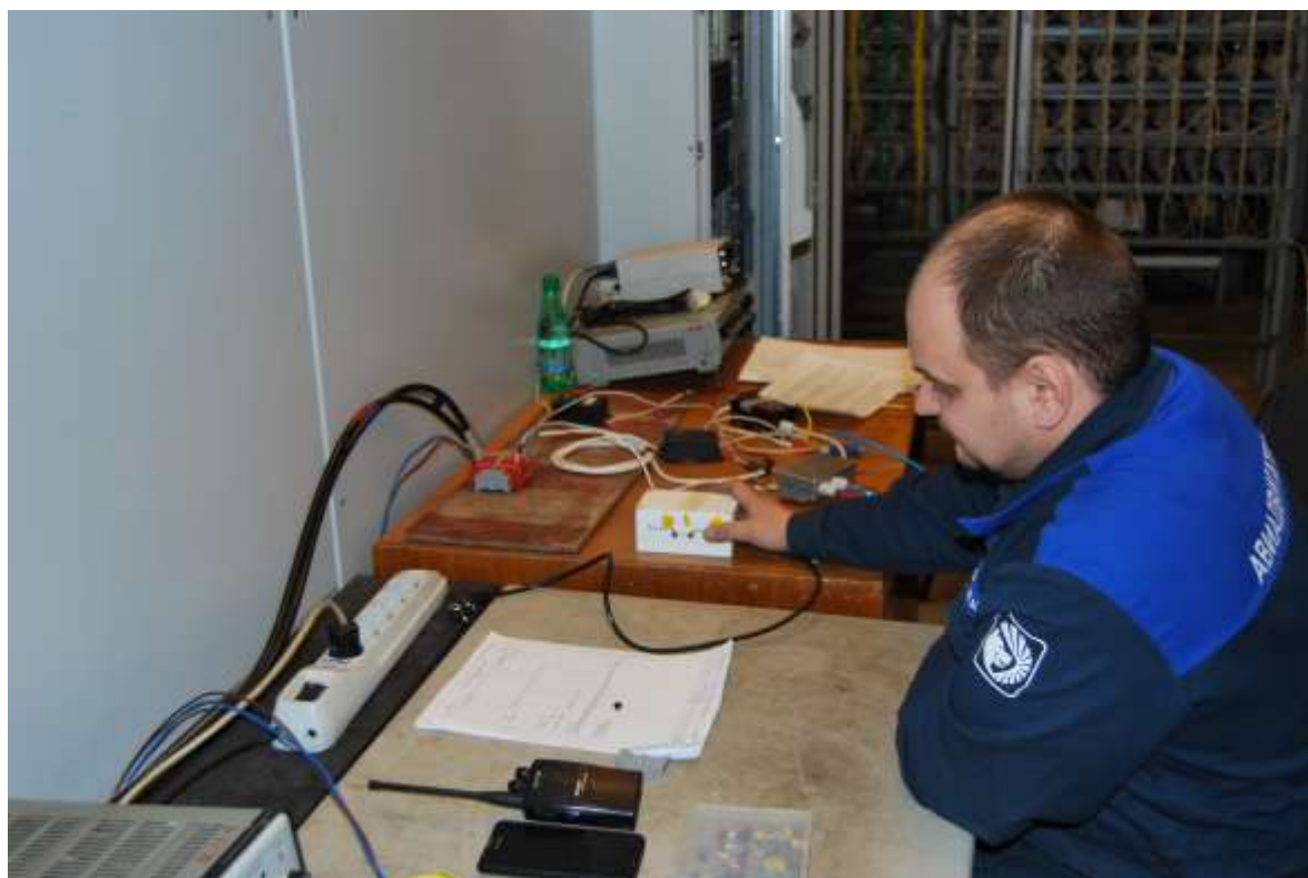
Рисунок 6.41 – Изменение (из другого бокса) параметров электрического напряжения на электродах ЭУВТ варьированием БП при огневых испытаниях (по утвержденной программе) форсуночных модулей
