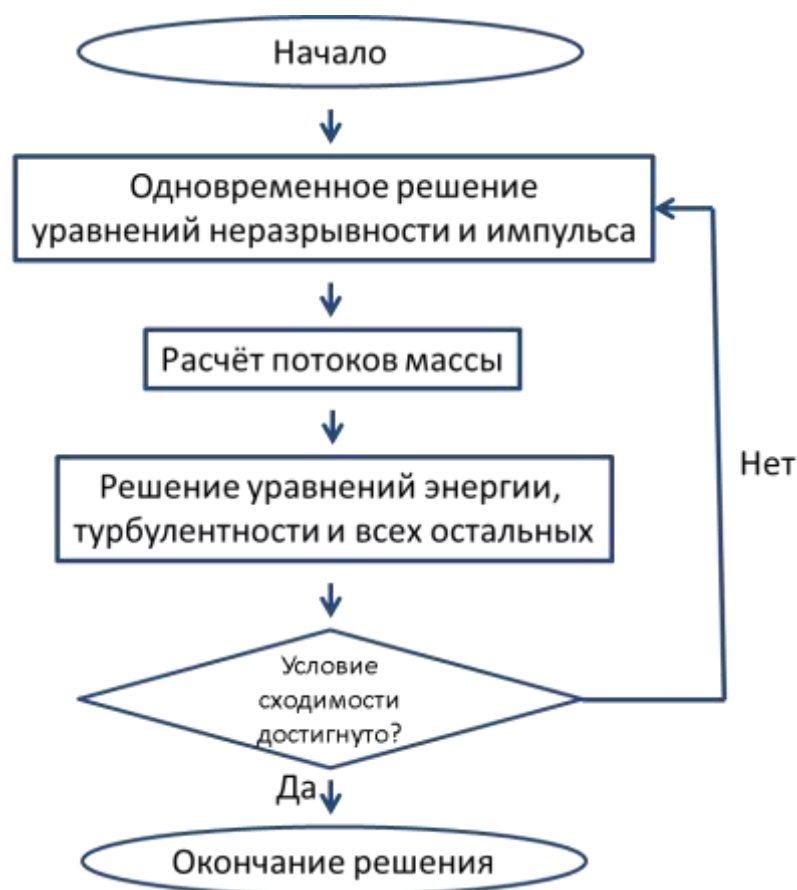
Рисунок 5.22 – Схема выполнения расчёта в ANSYS Fluent
