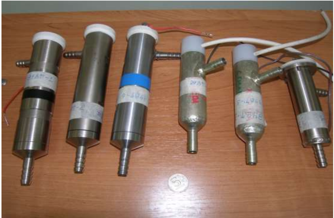
Рисунок 5.41 – Электрические устройства воздействия на топливо ЭУВТ-1, ЭУВТ-2, ЭУВТ-3, ЭУВТ-4, ЭУВТ-5, ЭУВТ-6 с различными конструктивными параметрами
