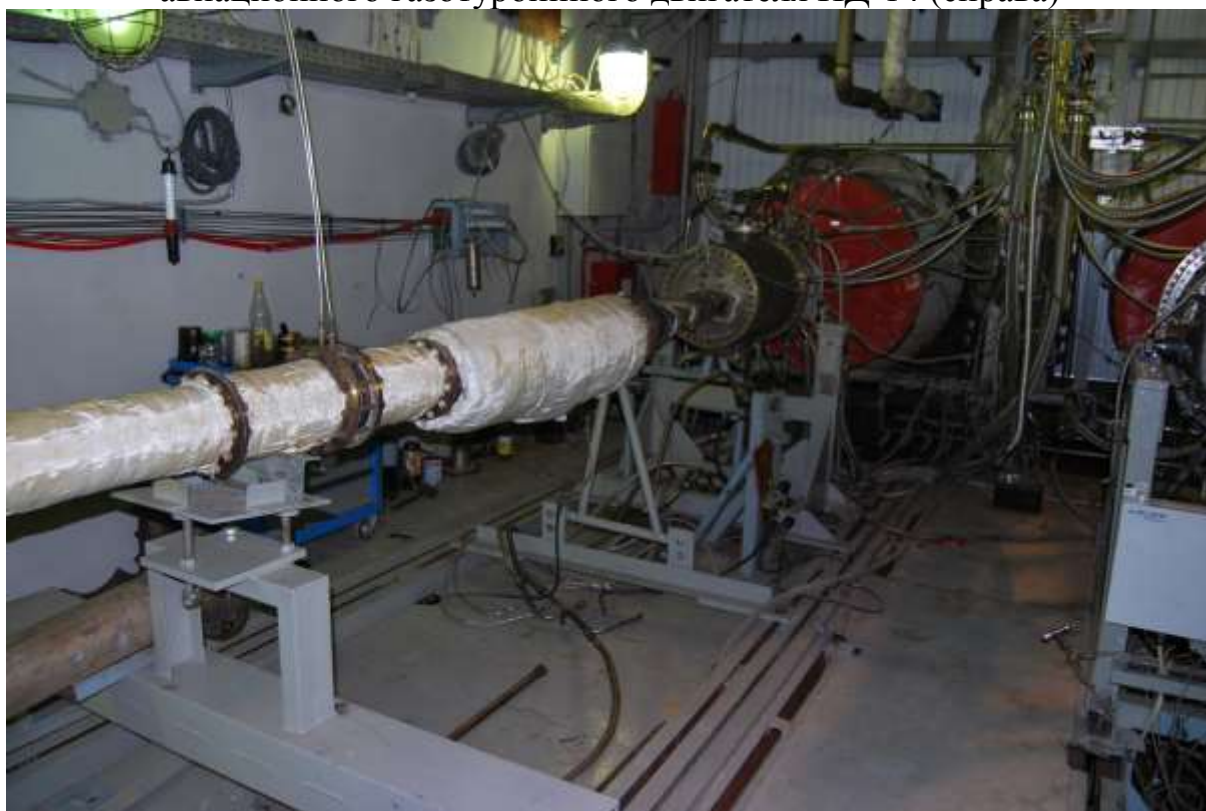
Рисунок 6.39 – Линия подвода сжатого до 22 атм нагретого до температуры 826 К воздуха к пятигорелочному отсеку. В центре трубопровода видна врезанная мерная диафрагма расходомера воздуха
