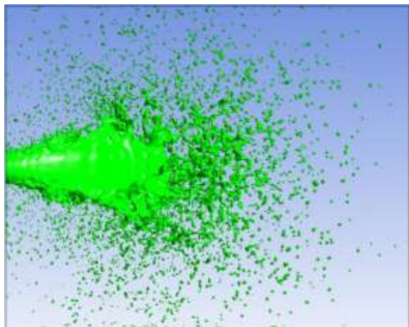
Рисунок 5.24 – Распределения капель жидкости по сечению канала при различных моделях турбулентности
