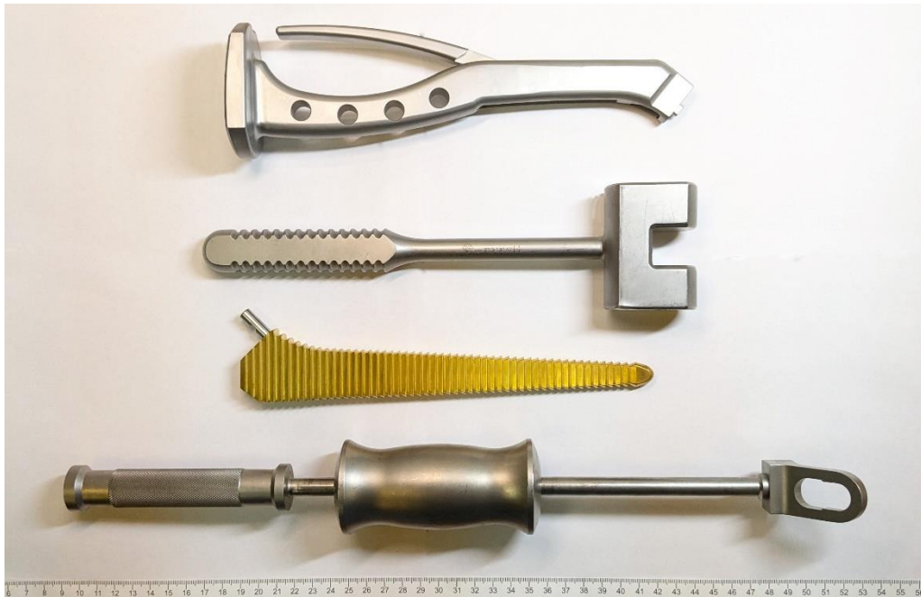
Рисунок 4.1 – Рабочая часть и рукоятка рашпиля для операции эндопротезирования тазобедренного сустава
