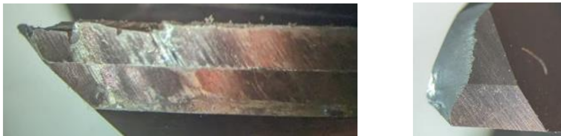
Рисунок 4.22 – Внешний вид режущих кромок фрезы после обработки образца сплава Ti-8,7Al-1,5Zr-2Mo с 0,4 %
