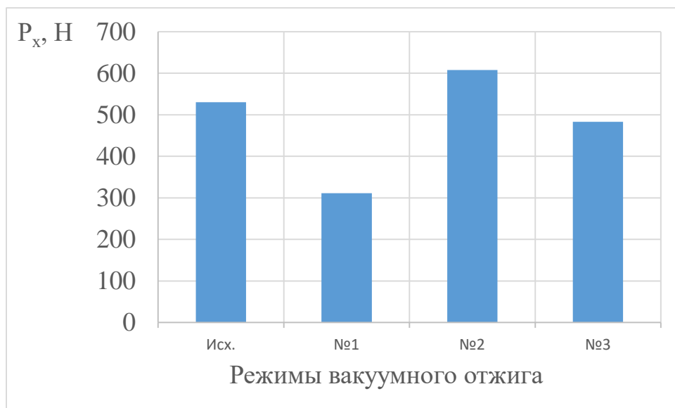
Рисунок 4.20 – Влияние режимов вакуумного отжига на силу резания P_x при фрезеровании образцов сплава Ti-8,7Al-1,5Zr-2Mo
