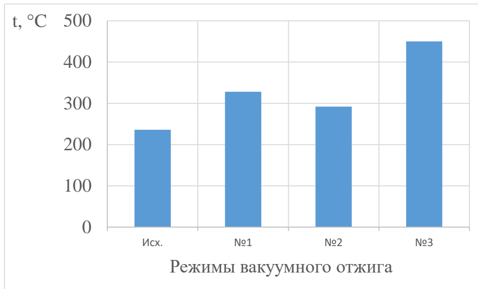
Рисунок 4.21 – Влияние режимов вакуумного отжига на температуру в зоне резания при фрезеровании образцов сплава Ti-8,7Al-1,5Zr-2Mo
