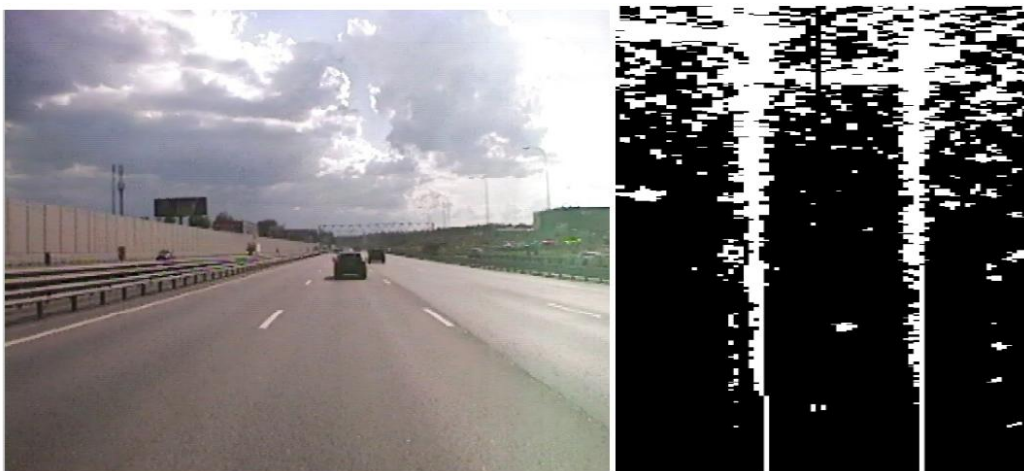
Рисунок 13 - Оптическое и радиолокационное изображения участка асфальтовой дороги с металлическими ограждениями с нанесёнными линиями обочин
