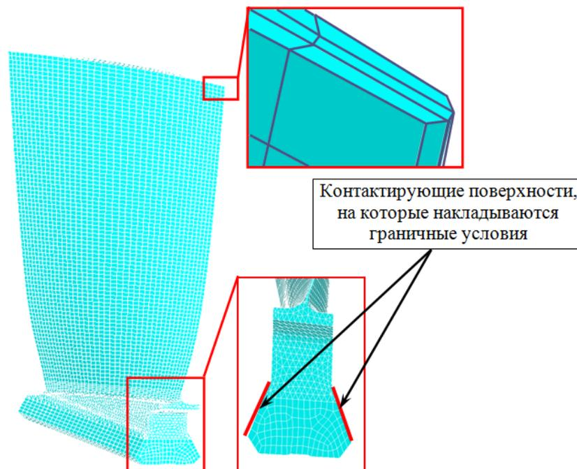
Рис. 3 Конечноэлементная модель лопатки
