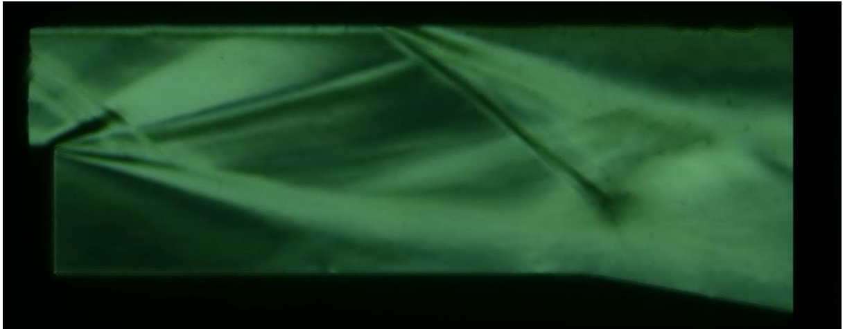
Рисунок 4.3 – Структура течения в тестируемой камере дожигания без подачи газа за уступ
