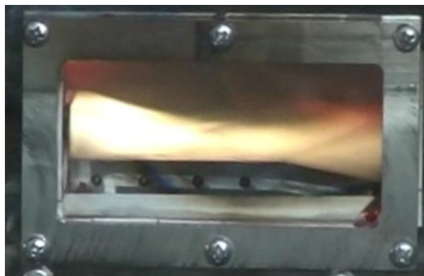
Рисунок 4.9 – Горение водорода за уступом: а – спектрозональная съемка, б – прямая видеорегистрация.
