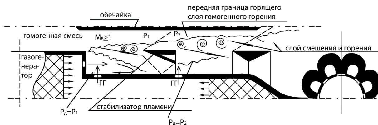
Конструктивная схема со ступенчатым центральным корпусом
