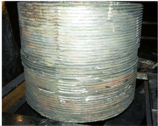
Рисунок 11. Разрушение коррозией внешней резьбы колонны под основанием пресса 100 МН
