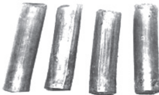
Рис. 11. Заготовки из никелевого сплава ЖС6-КП, полученные гидродинамическим выдавливанием с использованием в качестве смазки стеклографитовой среды [21]
