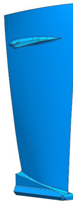
Рисунок 17 – Лопатка из титанового сплава ВТ6
