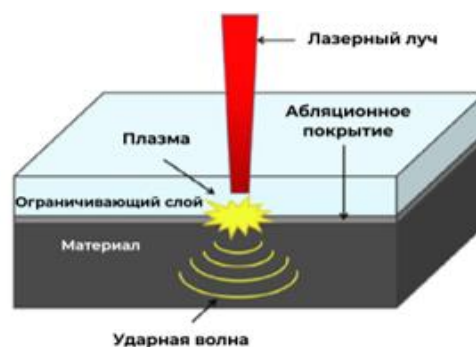
Рисунок 1 – Схема лазерной ударной обработки
