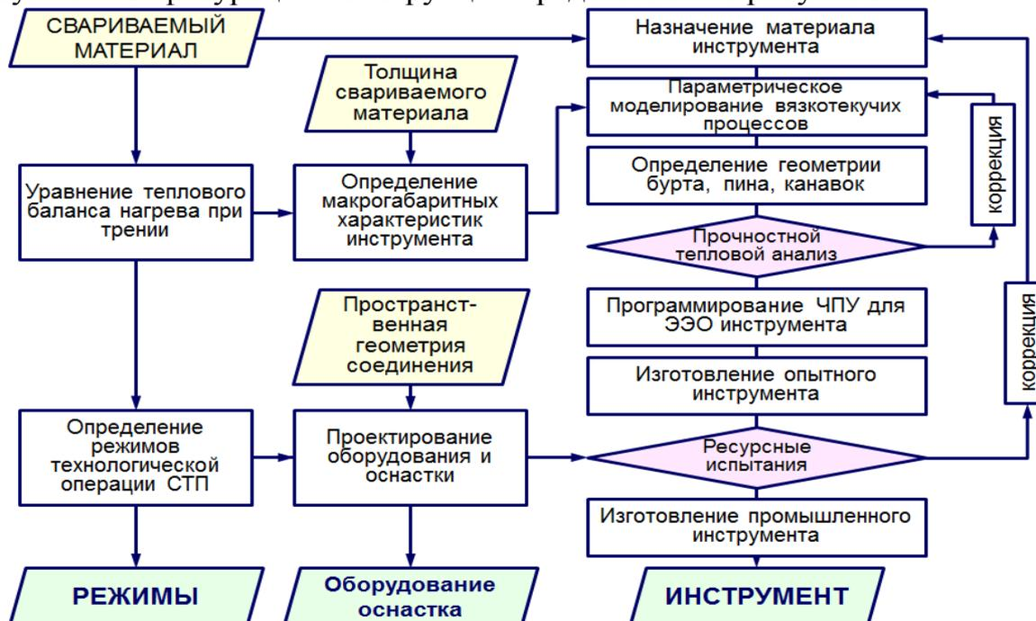
Рисунок 5 – Методика отработки технологического обеспечения сварки трением перемешиванием
