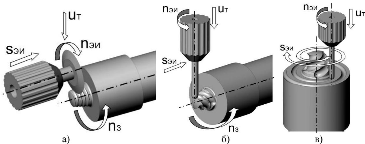
Рисунок 17 – Технологические схемы формообразования геометрии инструмента ЭЭФ:
