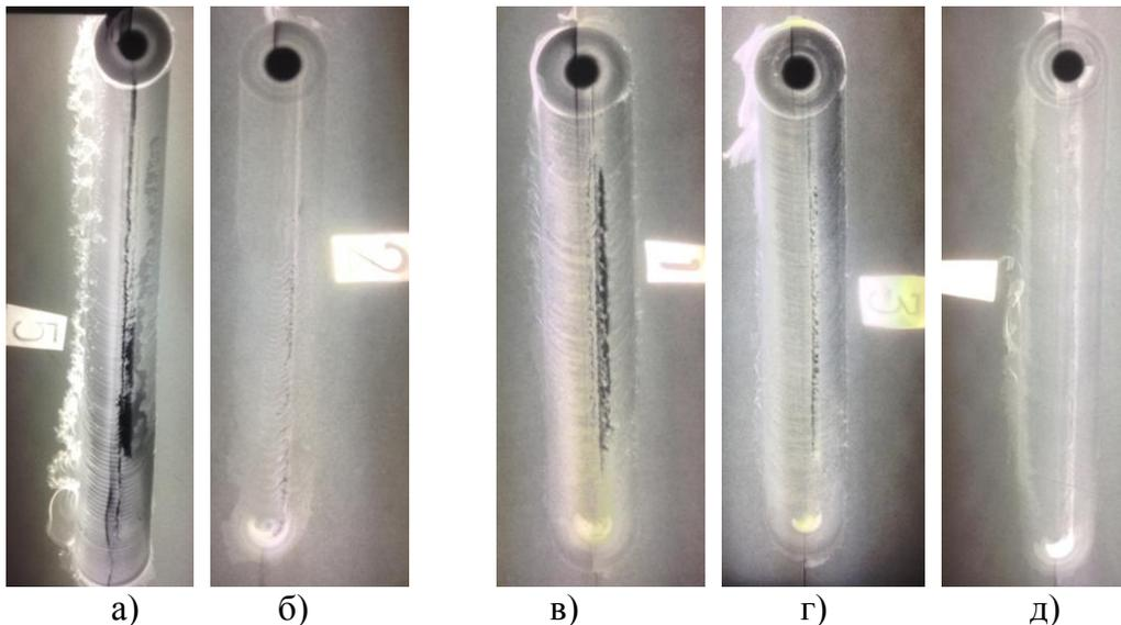
Рисунок 9 – Результаты радиографического контроля сварных швов титана ВТ6 (а, б) и стали 12Х18Н10Т (в-д), после СТП на различных режимах:
