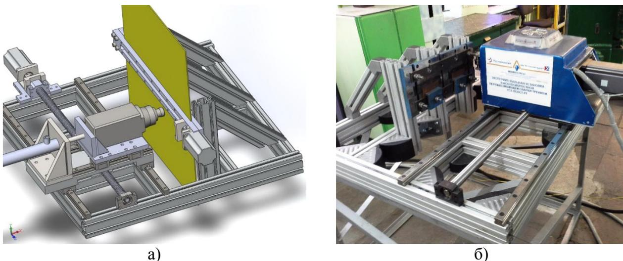
Рисунок 20 – Установка высокоскоростной сварки трением перемешиванием (ВСТП):
