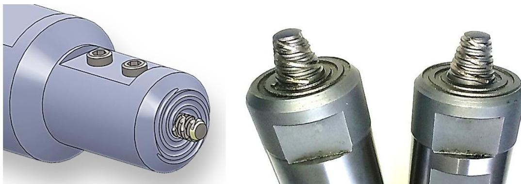
Рисунок 19 – Проекты прогрессивного инструмента: 3D модель и готовые изделия
