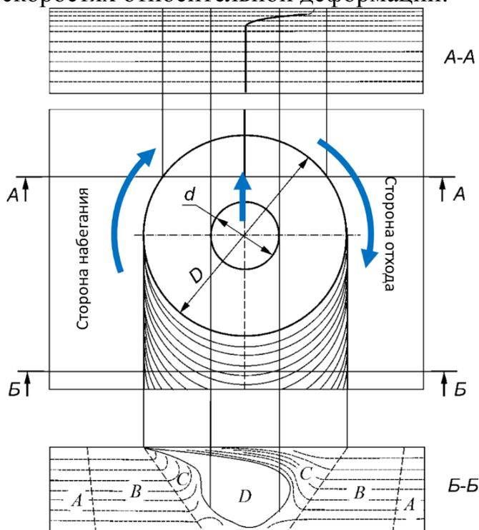
Рисунок 3 – Формирование шва при СТП с указанием зон в его сечении: А – основной материал; В – зона термического влияния; С – зона термомеханического (термомеханического) воздействия; D – зона перемешивания
