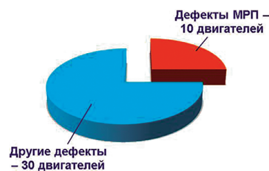
Рис. 1. Дефекты МРП двигателя АЛ-31Ф, приведшие к выключению в полете (октябрь 2011 — август 2013 г.)
