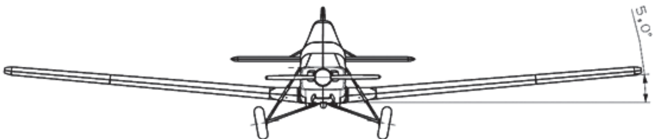
Рис. 3. Угол поперечного положительного V
