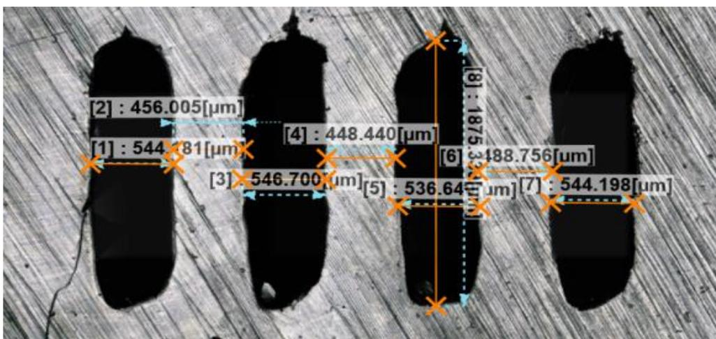
Рисунок 6 – Общий вид образца с каналами
