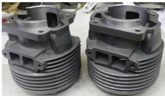
Рисунок 17.3 – Цилиндры ДВС, полученные СЛС, после механической обработки
