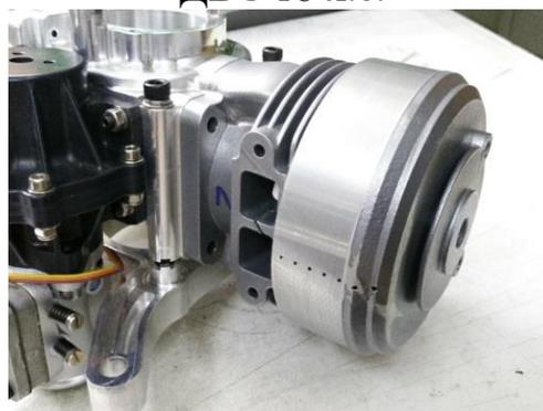
Рисунок 17.4 – Примерка цилиндра на картер после СЛС
