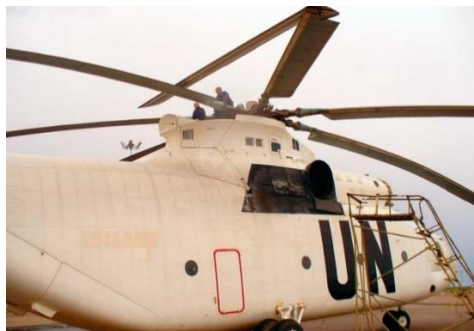
Рисунок 1 – Примеры последствий воздействия ветра на невращающиеся лопасти несущего винта вертолётов а – Ми-8, б – Ми-26
