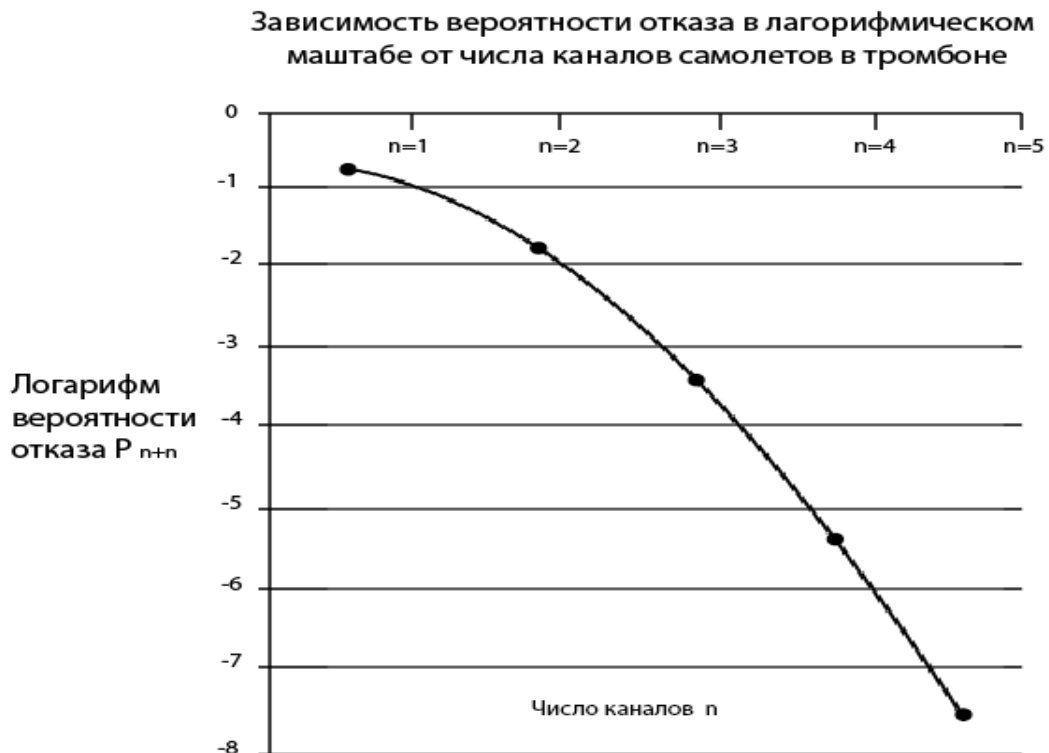
Рис. 5.5. Зависимость вероятности отказа в обслуживании тромбоном от допустимого числа самолетов в очереди.
