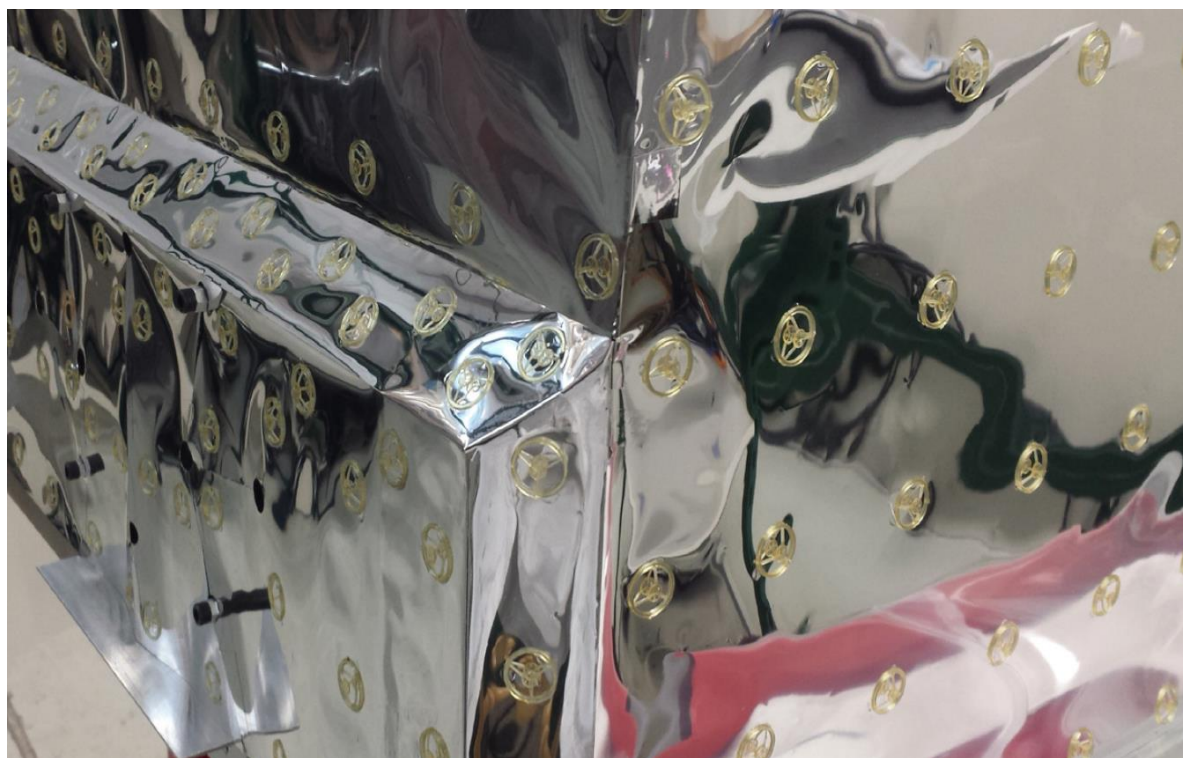
Рисунок 1.4. Дискретные полимерные прокладки [12], изготовленные методом микроформования, для разделения слоев изоляции IMLI компании Quest
