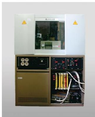
Рисунок 4.2 - Общий вид дифрактометра ДРОН 4–07
