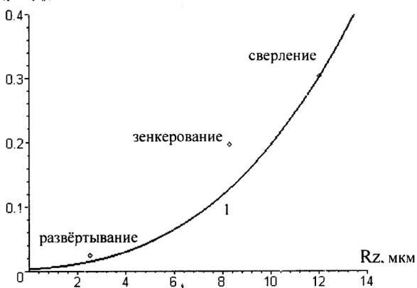
Рис. 3. Влияние шероховатости на герметичность заклёпочных соединений:  $q = 400$  МПа (кривая 1 получена для постоянных значений  $\beta$  и  $\nu$  для сверления)
