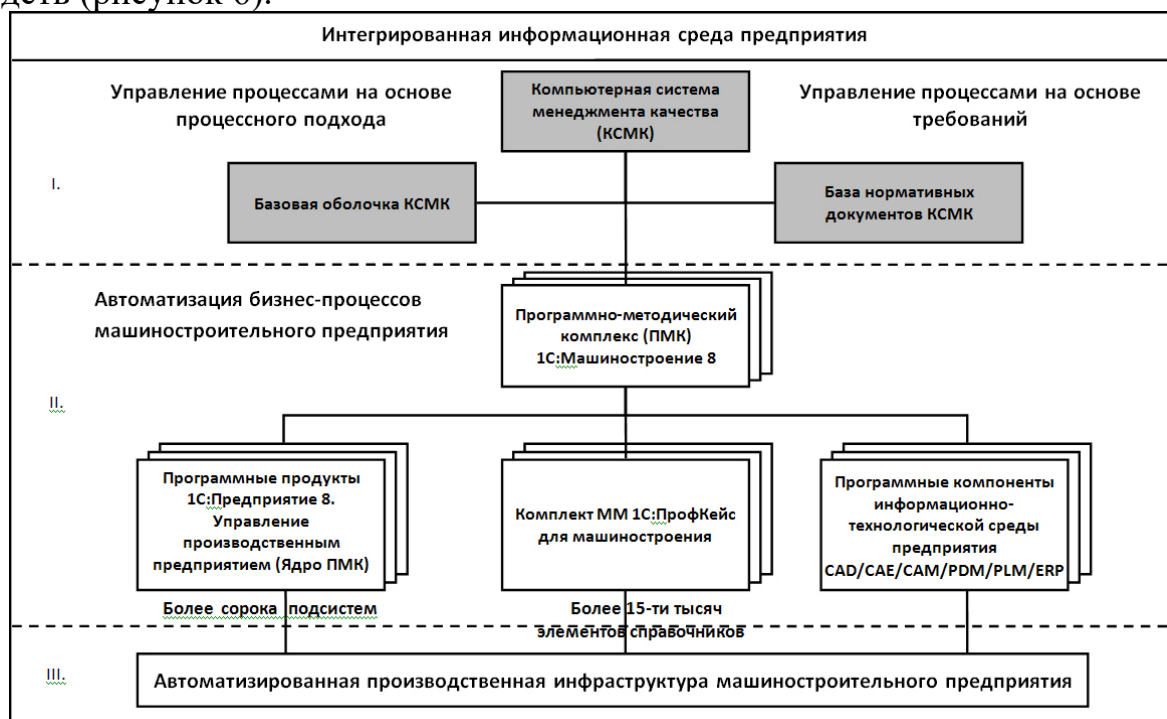
Рисунок 6 – Структурная модель компьютерной системы информационной поддержки системы менеджмента качества
