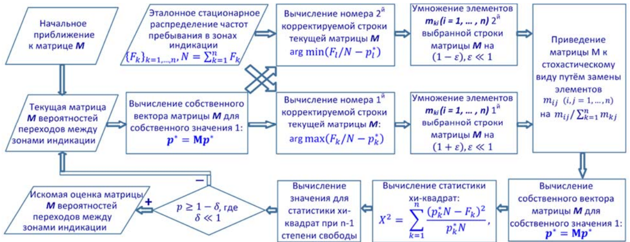
Рисунок 4. Численный метод определения взаимного расположения элементов индикации
