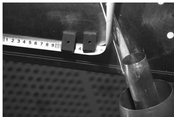
Рис.4 – Двойной ряд турбулизаторов на верхней и нижней поверхности крыла
