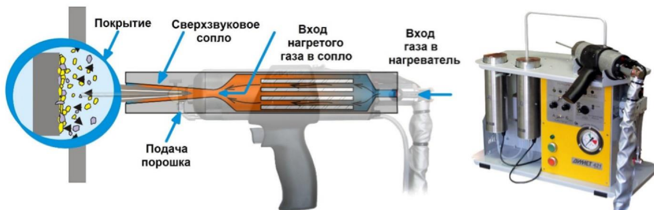
Рисунок 37 – Принципиальная схема процесса ХГДН
