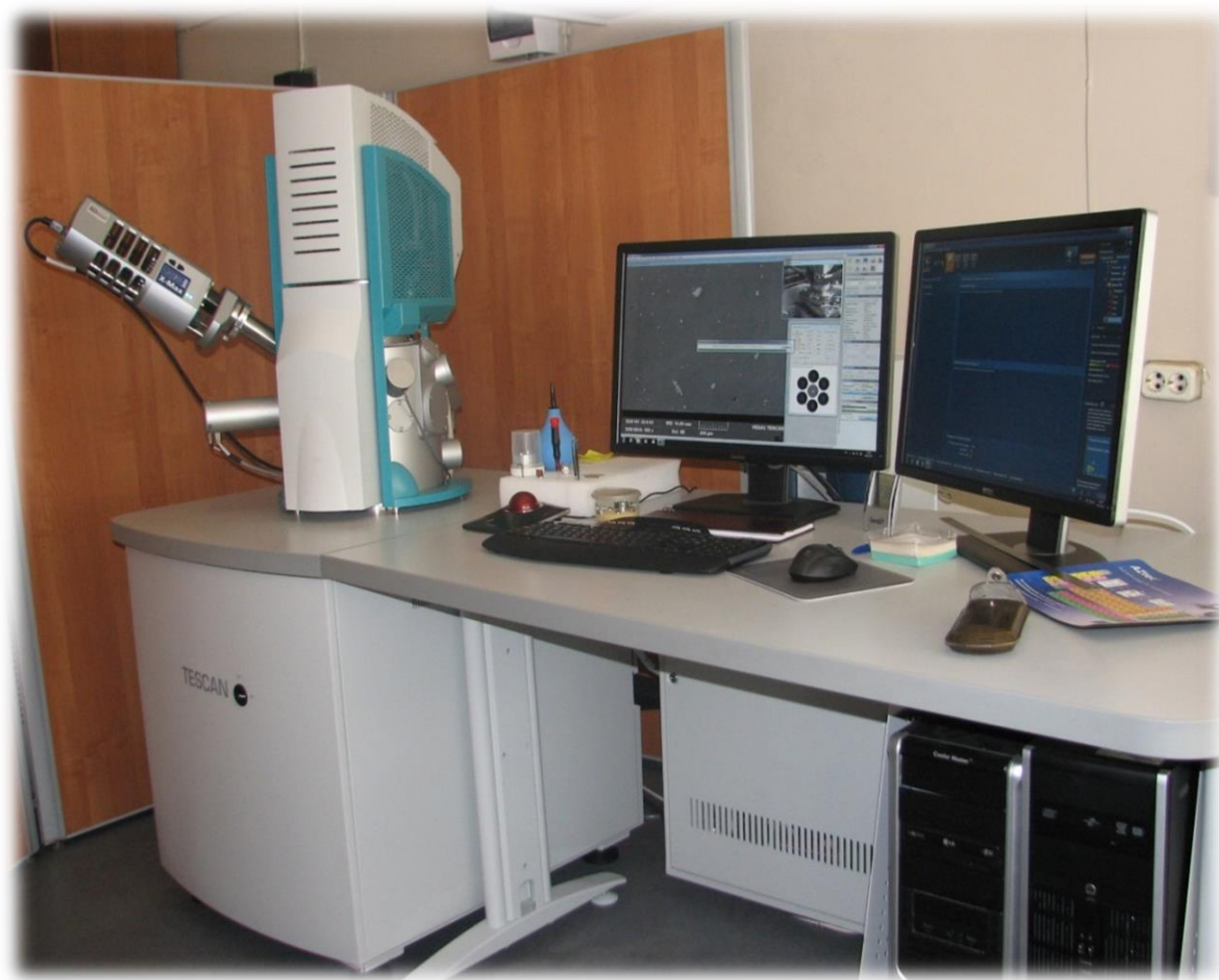
Рисунок 19 – Электронный сканирующий микроскоп TESCAN VEGA 3 SBH с системой рентгеновского энергодисперсионного микроанализа Oxford Instruments Advanced AZtecEnergy
