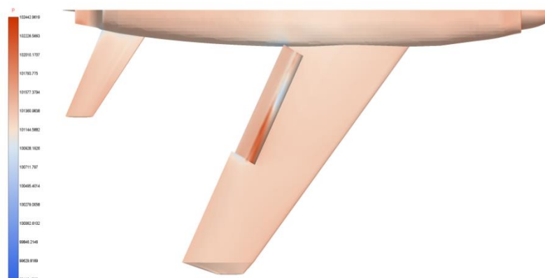
Рис. 3.11. Распределение давления по поверхности
