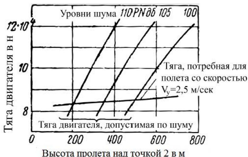
Рис. 1.18. Зависимость тяги двигателя от высоты полета при постоянном значении уровня шума
