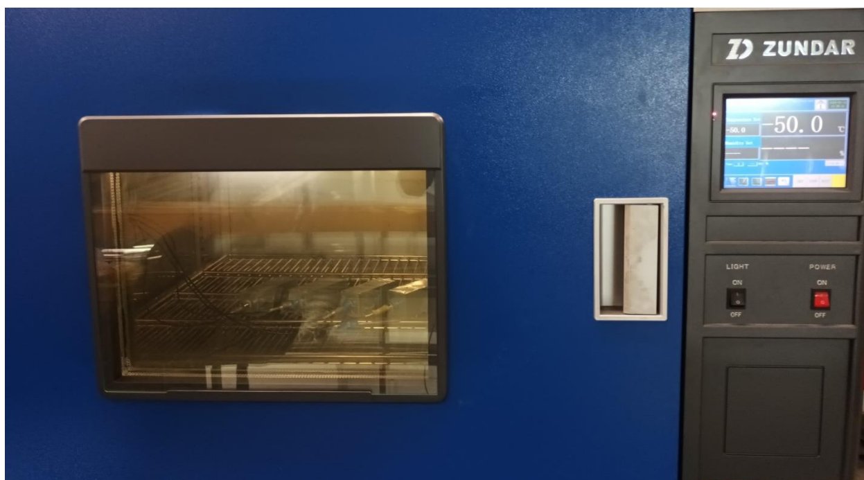
Рисунок 4.1.8 – Образцы №1-№4 во время проведения испытаний при задаваемом режиме воздействия окружающей среды минус 50°С
