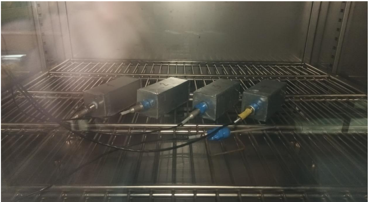
Рисунок 4.1.6 – Экспериментальные образцы №1-№4 помещенные в климотермокамере
