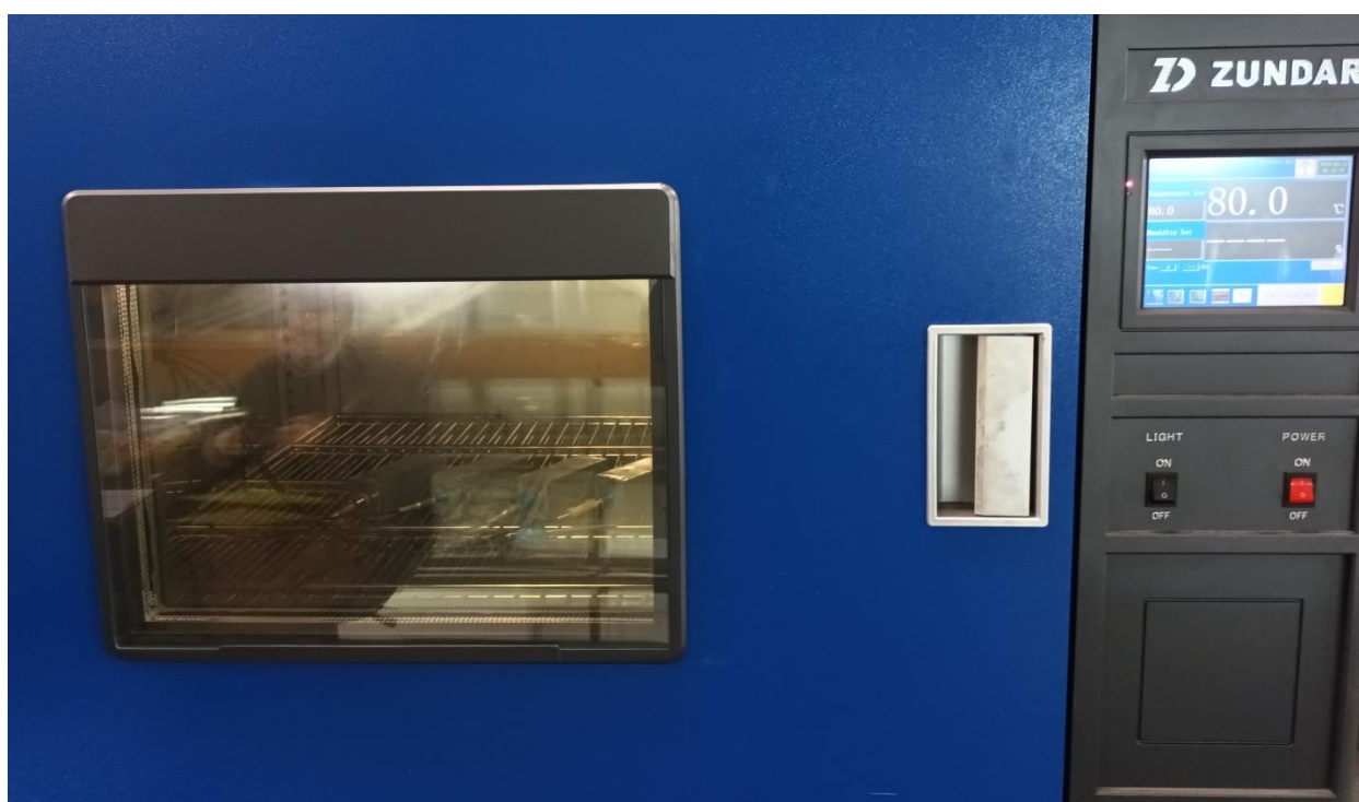
Рисунок 4.1.9 – Образцы №1-№4 во время проведения испытаний при задаваемом режиме воздействия окружающей среды плюс 80°С
