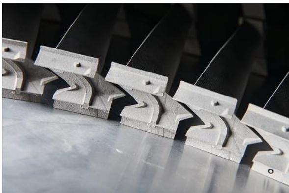
Рисунок 2 – Внешний вид рабочих лопаток, изготовленных из сплава КХ28М6
