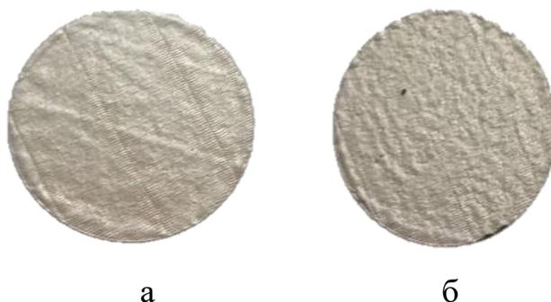
Рисунок 7 – Внешний вид образцов а) с островковой диагональной штриховкой, б) с зигзагообразной штриховкой
