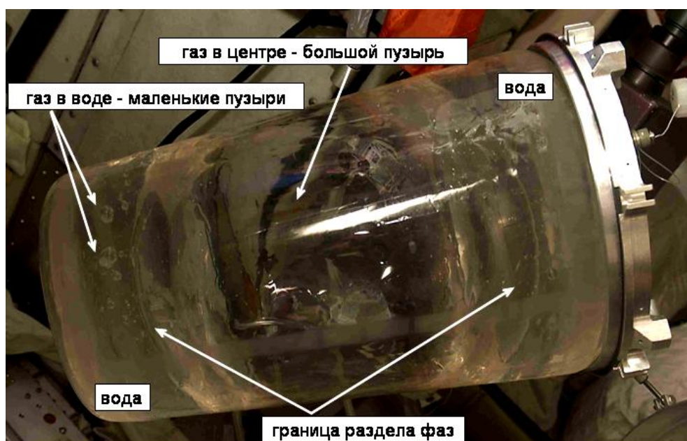
Рис. 8. МКС 21.10.2005 г. Газ в воде для СГК «Электрон-ВМ» (объем емкости 22 л).
