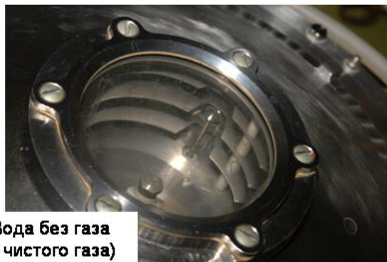
Рис. 12. Подготовка воды для СГК «Электрон-ВМ» на МКС. Вода в сепараторе газа.
