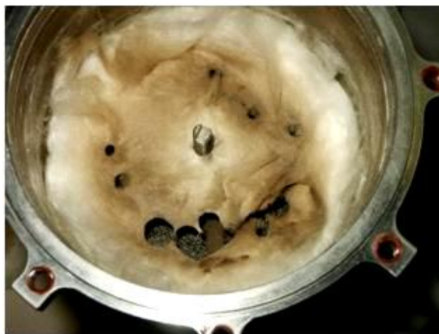
Рис. 9. Оплавление стекловолкна в блоке дожигания ТБ 008 (фото после спуска на Землю).
