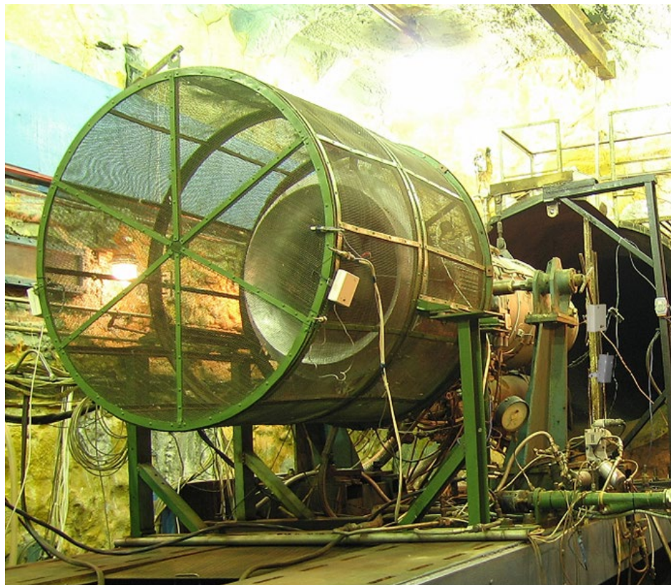
Рисунок 6.1 – Двигатель-демонстратор АИ-25ТЛ, установленный на стенде У-7М ЦИАМ
