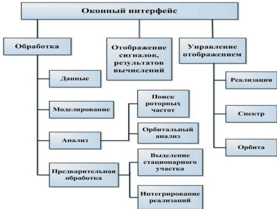
Рисунок 4.34 – Структура макета программного обеспечения модуля обработки вибросигналов
