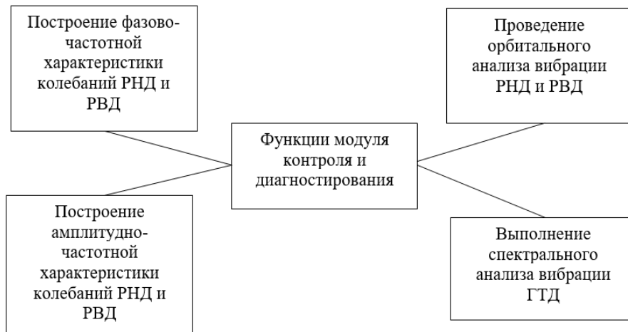
Рисунок 4.27- Функциональная схема модуля контроля и диагностирования роторных систем
