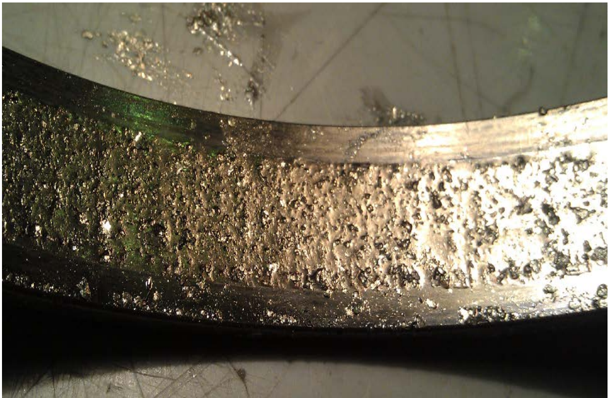
Рисунок 4.4 - Состояние беговой дорожки наружного кольца экспериментального подшипника
