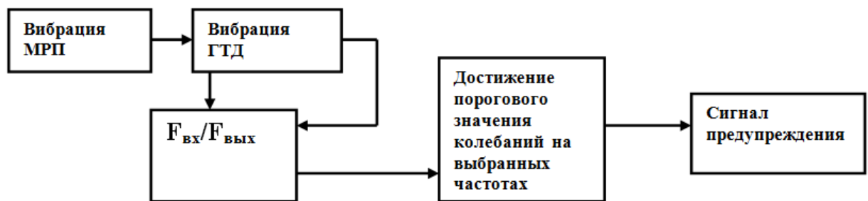
Рисунок 1.7- Функциональная схема анализа передаточных функций
