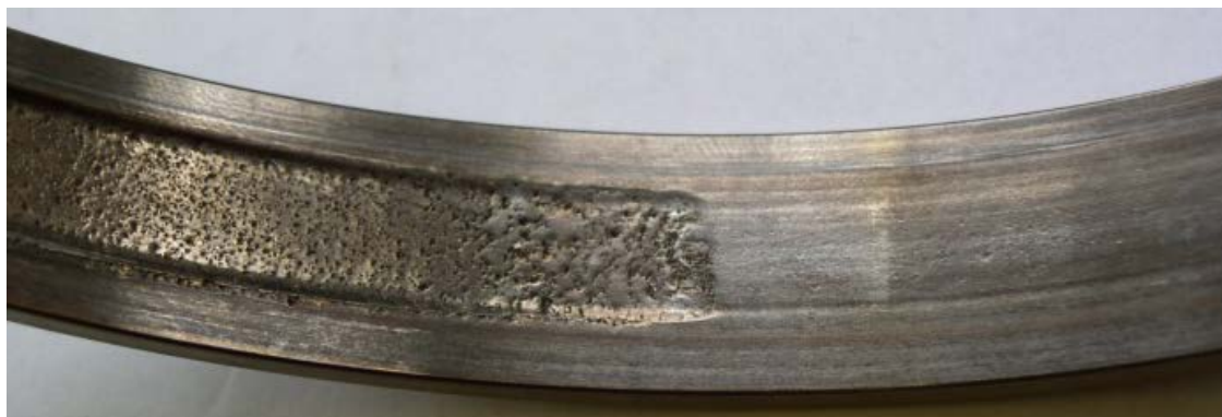
Рисунок 4.1- Начальное состояние беговой дорожки экспериментального подшипника
