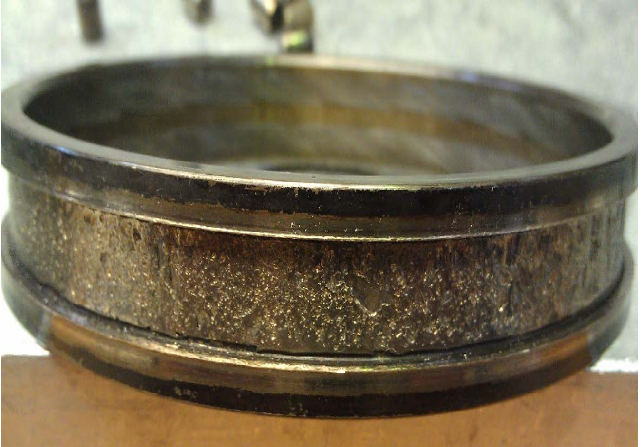
Рисунок 4.5 - Состояние беговой дорожки внутреннего кольца экспериментального подшипника
