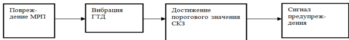
Рисунок 1.2-Функциональная схема контроля по предельному уровню общей вибрации
