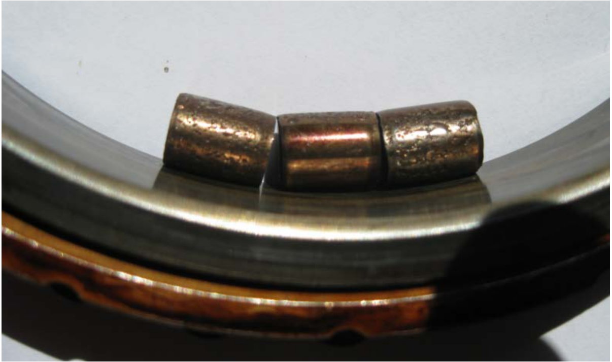
Рисунок 4.6 - Состояние тел качения внутреннего кольца экспериментального подшипника
