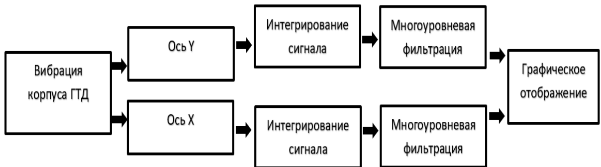
Рисунок 3.1 – Структурная схема проведения орбитального анализа вибрации
