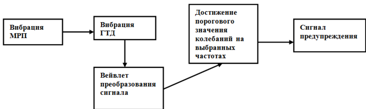
Рисунок 1.6- Функциональная схема метода диагностики с использованием вейвлет анализа
