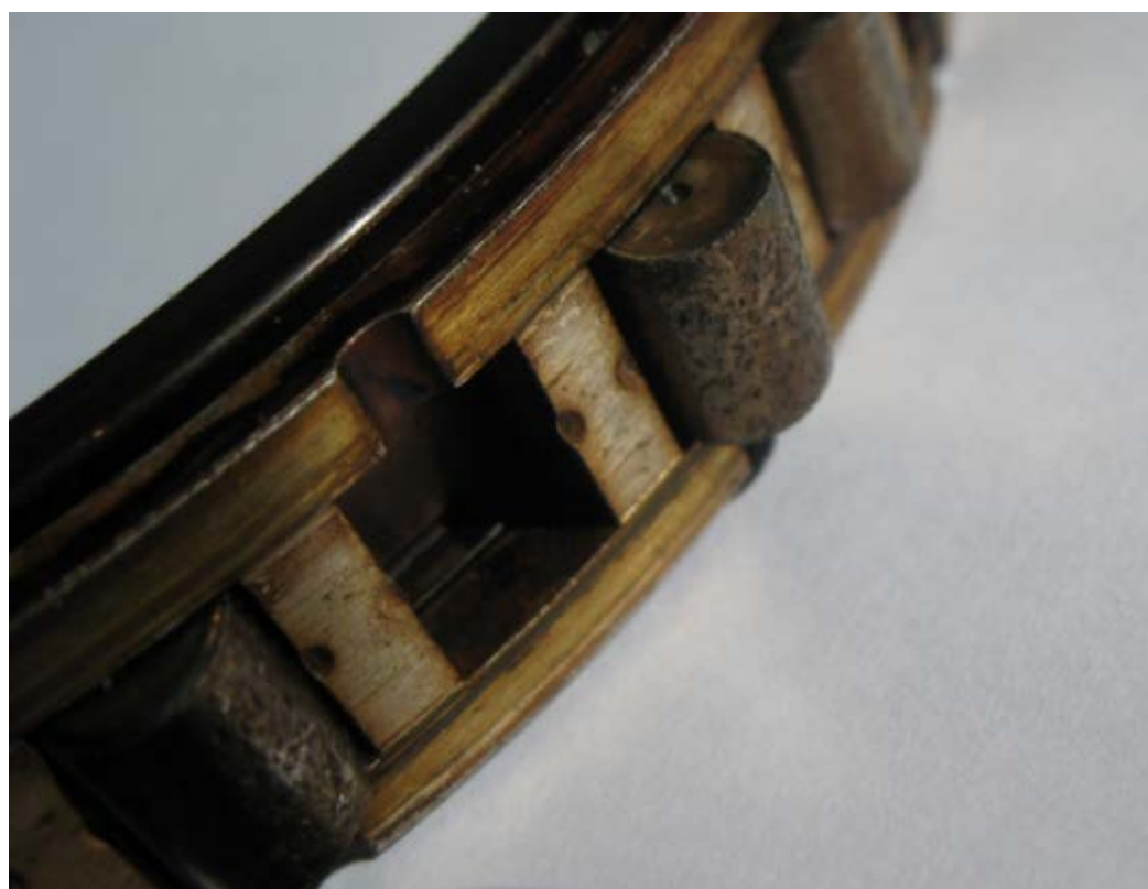
Рисунок 4.2- Начальное состояние тел качения экспериментального подшипника
