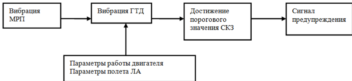
Рисунок 1.3- Функциональная схема анализа регрессионной вибромодели
