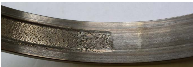
Рисунок 2.8 - Развитые усталостные повреждения на наружном кольце
