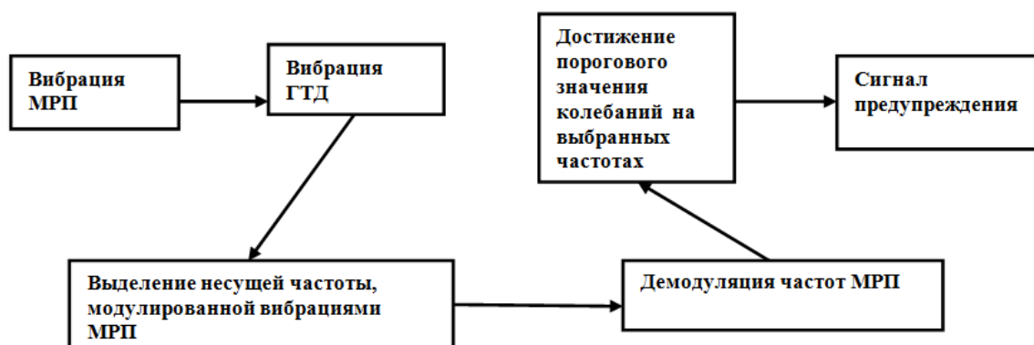
Рисунок 1.5-Функциональная схема метода анализа с использованием огибающей спектра вибрации
