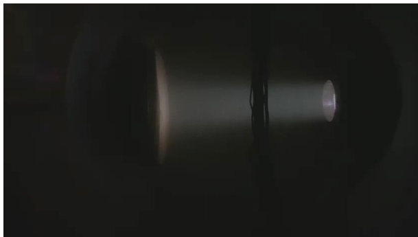
Рисунок 109 – Фотография пучка, генерируемого ВЧИД в процессе испытаний на ксеноне
