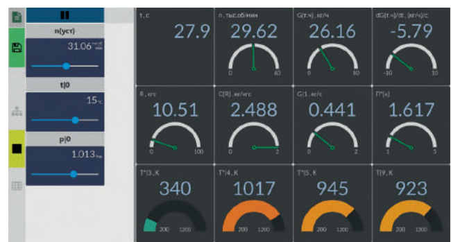
Рис. 5. Элементы управления и индикаторы параметров ГТД «АСТРА-9»
