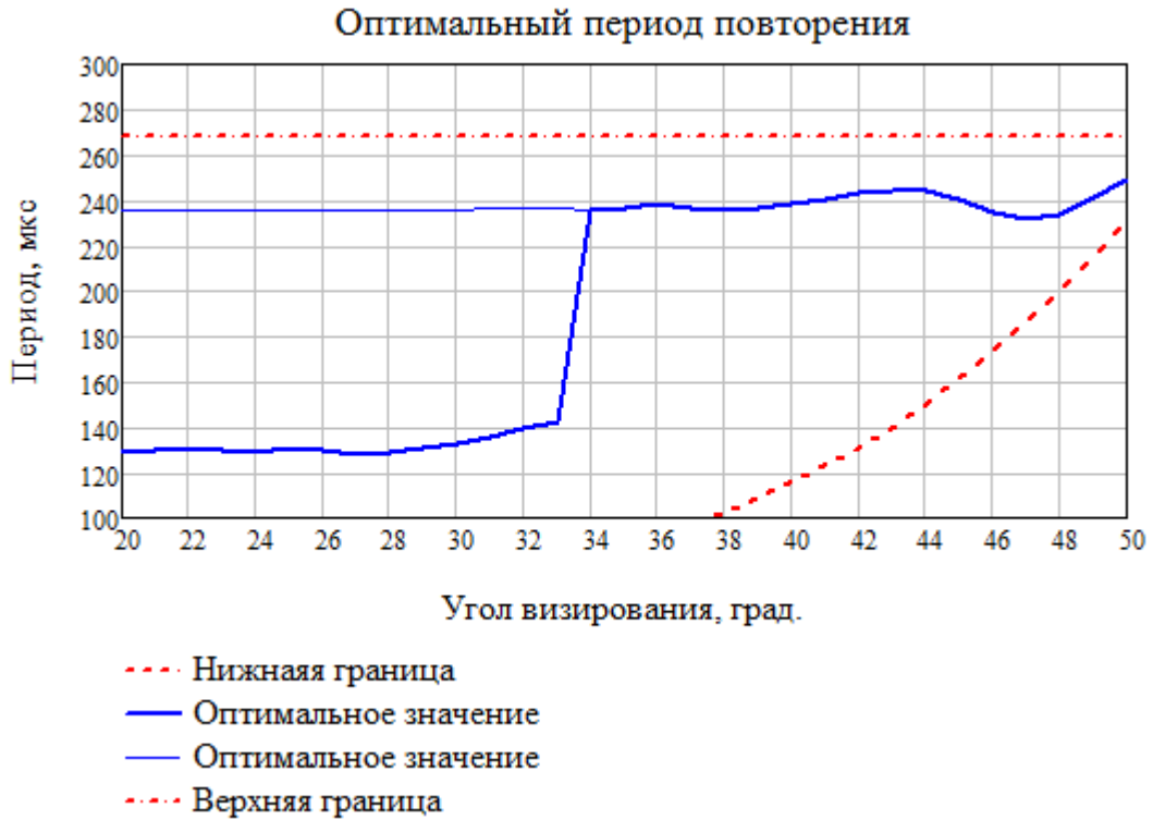
Рисунок 2.24 – Граничные и оптимальные значения периода повторения в рабочем диапазоне углов визирования
