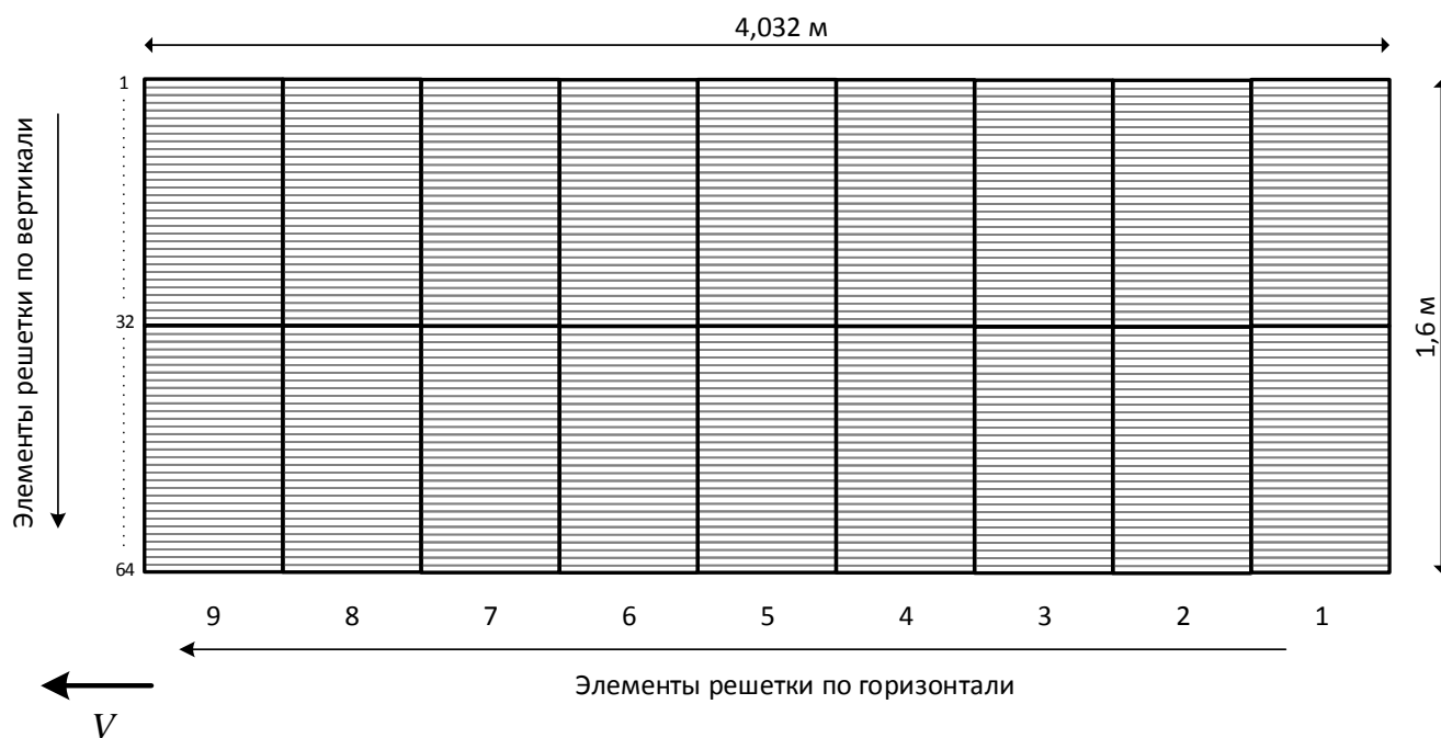
Рисунок 2.1 – Конфигурация исследуемой АФАР – вид со стороны антенного полотна
