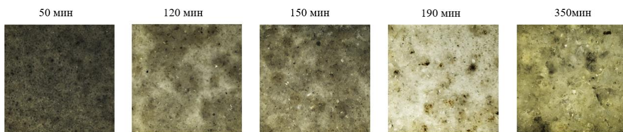
Рисунок 4.4 – Структура поверхностного слоя МДО покрытия на сплаве AlSi10Mg, полученного методом СЛС ( \times 20 )
