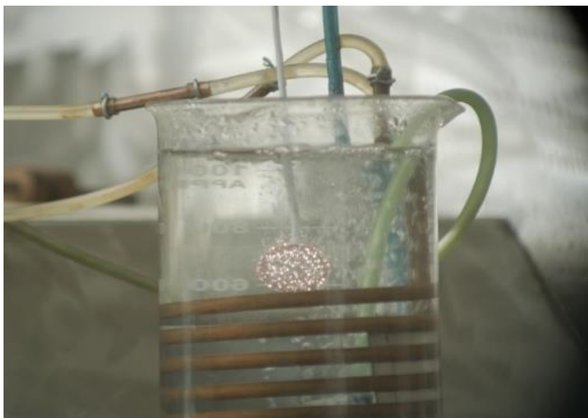
Рисунок 2.4 – Процесс микродугового оксидирования
