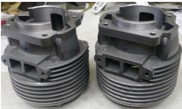
Рисунок 5.7 – Цилиндры ДВС, полученные СЛС, после механической обработки
