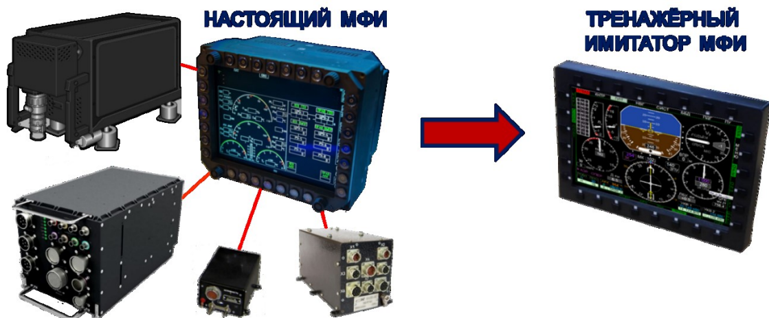
Рисунок 3. Целесообразность использования на учебных занятиях тренажёрного имитатора МФИ вместо комплекта из настоящего МФИ и оборудования, необходимого для его работы
