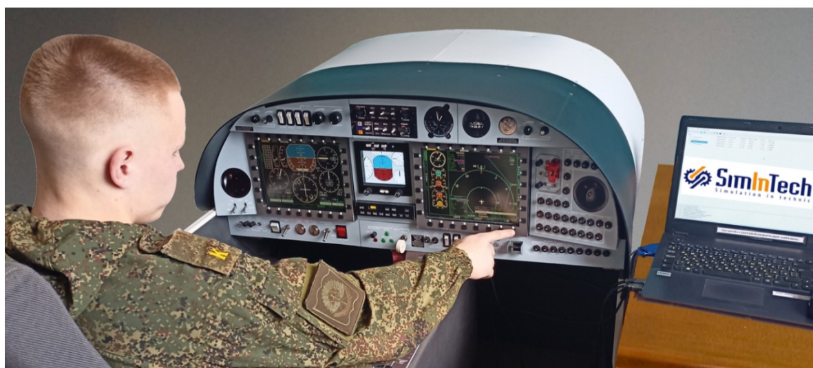
Рисунок 8. Разработанный полноразмерный макет кабины самолёта ДА-42Т с тренажёрными имитаторами МФИ
