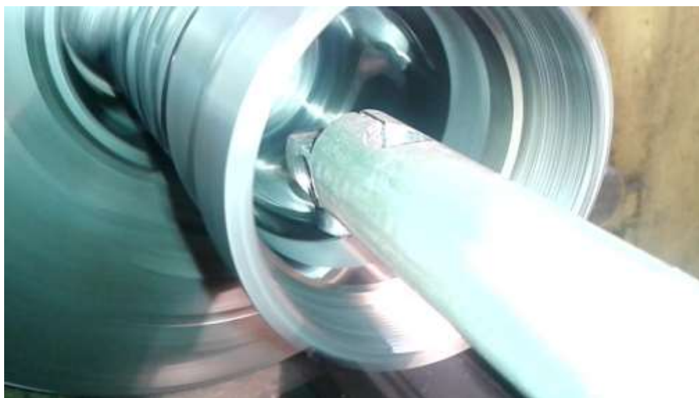
Рисунок 5.19 – Индентор во время выглаживания зеркала цилиндра с износостойким покрытием
