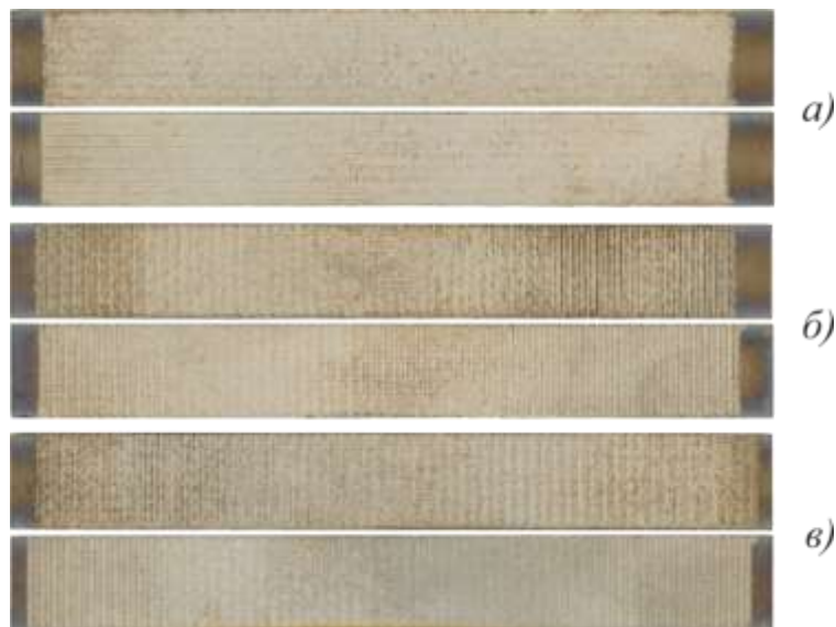
Рисунок 4.7 – Образцы из VT20: а) первого, б) второго, в) третьего типов после ЭИЛ электродом из Ag (верхняя пластина) и W (нижняя пластина) соответственно
