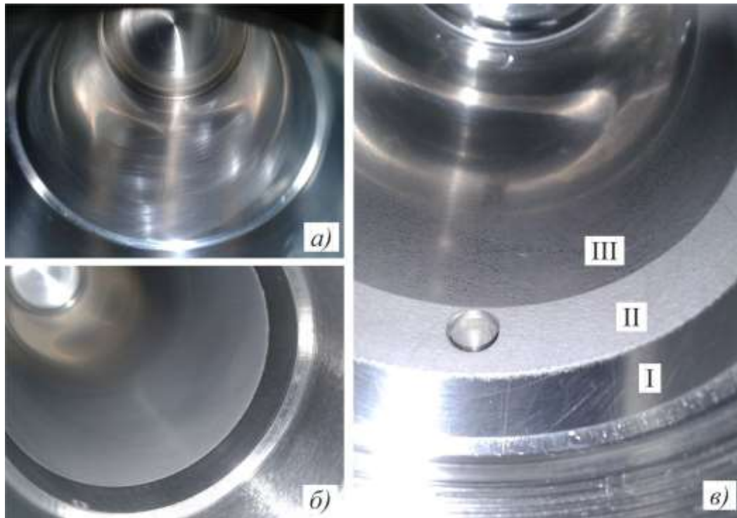
Рисунок 5.4 – Поверхность цилиндра: а) исходная, б) после ЛКО. в) поверхность цилиндра (I) после ЛКО (II) и алмазного выглаживания (III)
