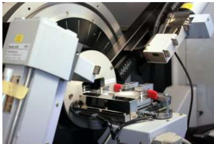
Рисунок 5.13 – Порошковый рентгеновский дифрактометр D8 ADVANCE
