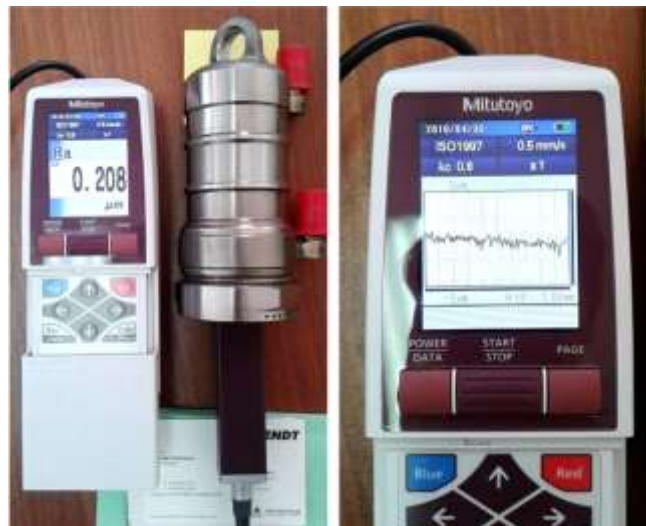
Рисунок 5.21 – Измерение параметров шероховатости поверхности зеркала цилиндра на SJ-210
