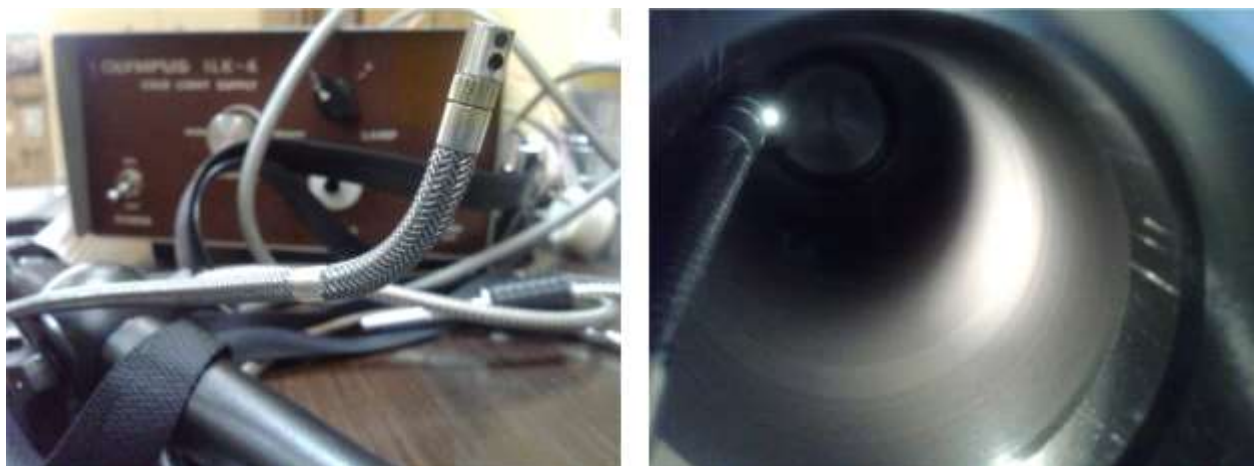
Рисунок 5.10 – Промышленный эндоскоп OLYMPUS ILK-4, и визуальный контроль поверхности ГЦ, выглаженной после ЛКО
