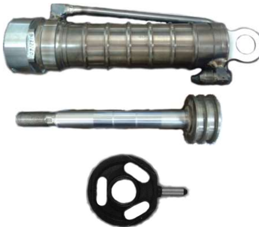
Рисунок 5.1 – Детали из титановых сплавов, упрочненных ЭИЛ и комбинированными способами
