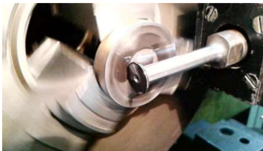
Рисунок 4.22 – Процесс обкатки ЛКО покрытия на образце ВТ20 роликом из закаленной стали
