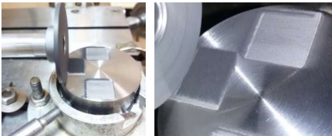
Рисунок 5.14 – Легирование титановых образцов VT20 после чистового точения
