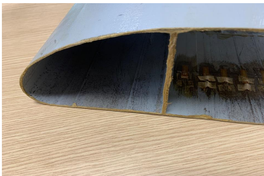
Рисунок 5.7 – Фрагмент конструктивно – подобного образца многостеночного закрылка
