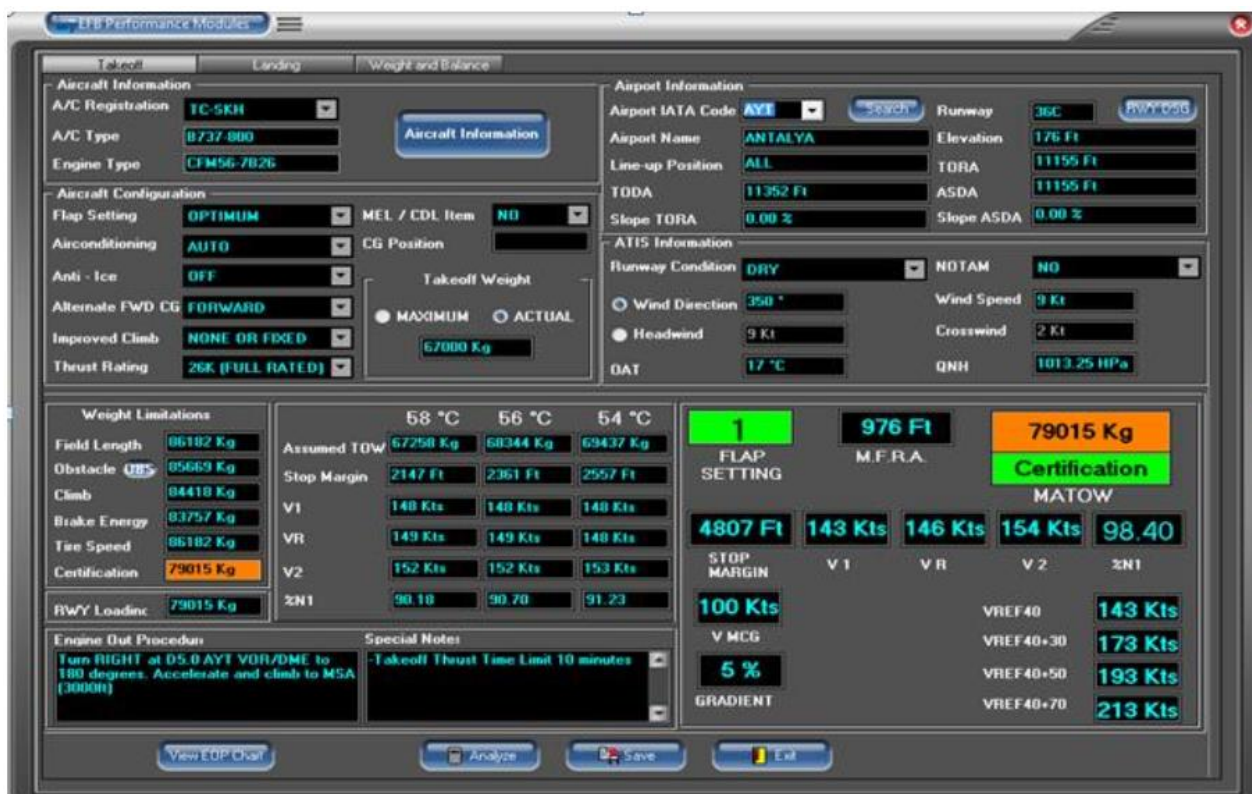
Рисунок 1.4 – Интерфейс ПО для расчета ВПХ, созданного турецкими исследователями и разработчиками (Metin Zontul, Uğur Batak, Orkun Polat)
