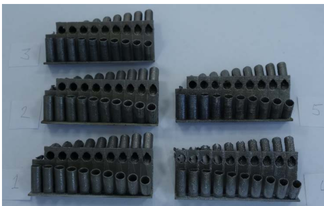
Рис. 14 – Напечатанные образцы (трубки с углами от 45° до 90°)
