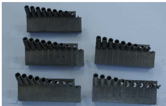
Рис. 15 – Напечатанные образцы (трубки с углами от 0 до 45°)
