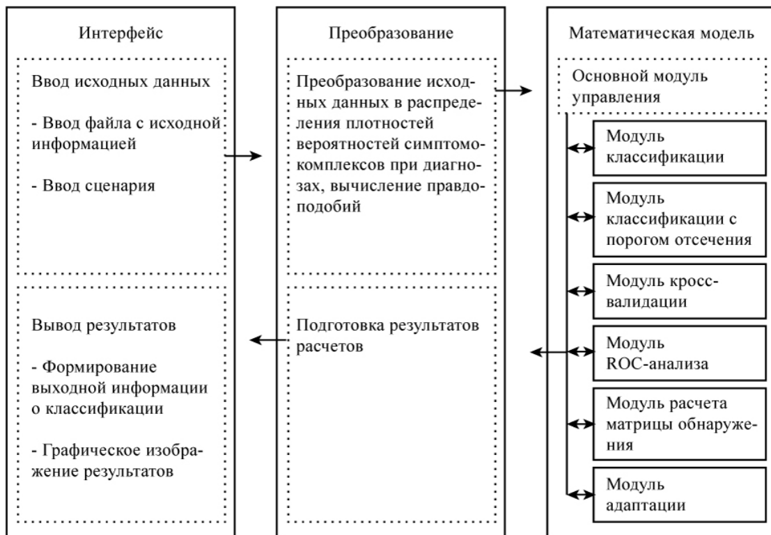
Рис. 3. Схема основных блоков СППР
