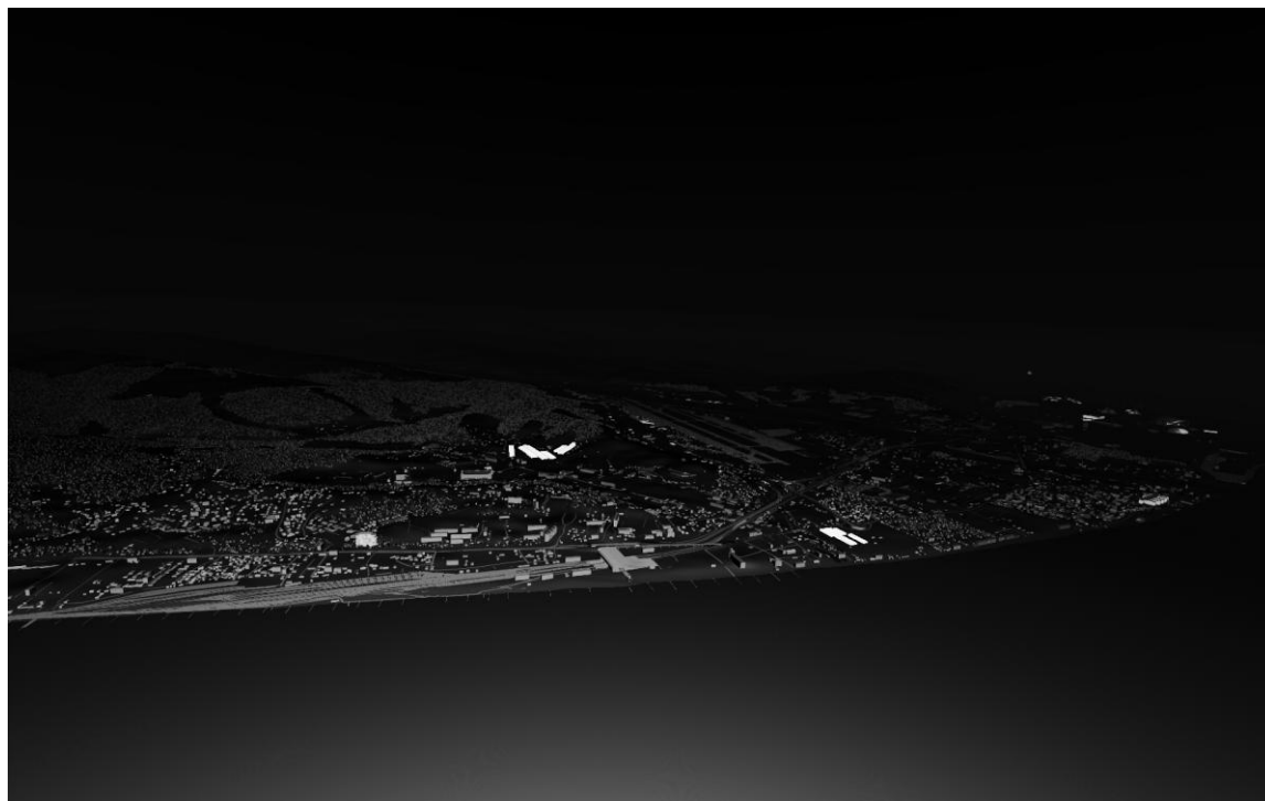
Рисунок 3 — Синтезированное тепловизионное изображение аэродрома в диапазоне 8-12 мкм, соответствующее регистрациям в сложных метеоусловиях (метеорологическая дальность видимости 2 км, влажность 90%, температура воздуха 30°C)
